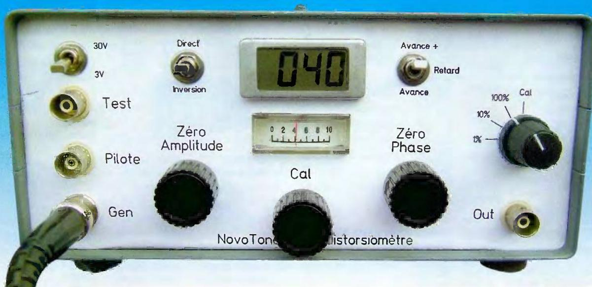
**Afin de compléter l'équipement de notre laboratoire de mesures, nous abordons aujourd'hui la réalisation d'un distorsiomètre. Le projet est entièrement analogique. Il permet la mesure du taux de distorsion des amplificateurs sur toute la gamme audio et peut mesurer des taux aussi faibles que 0,01 %.**
