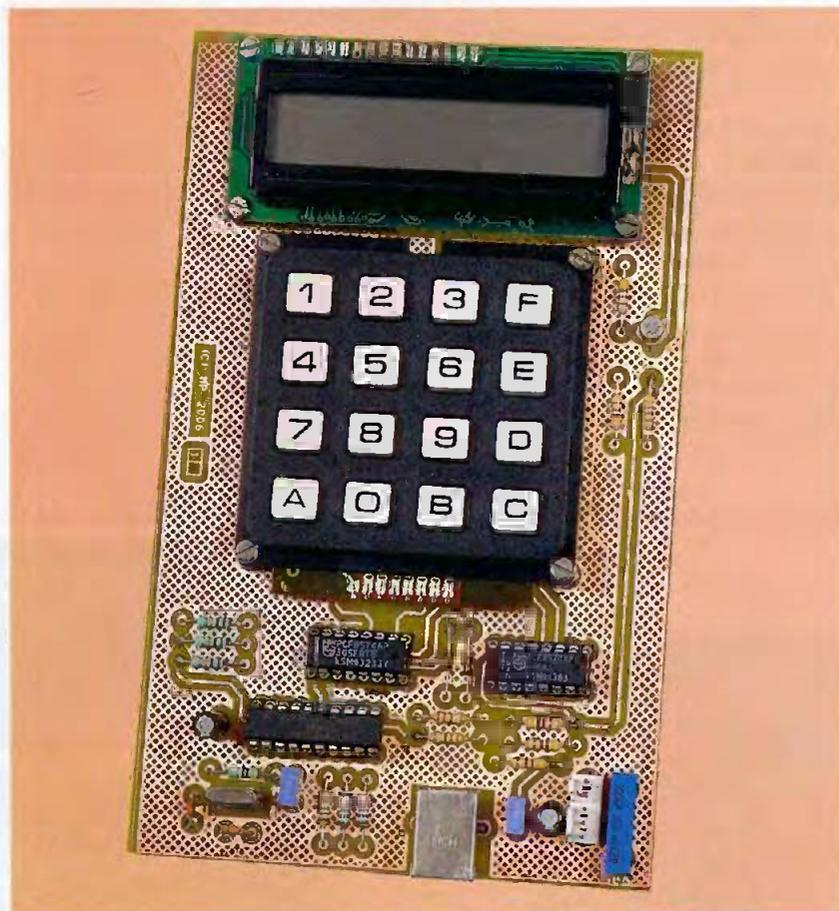
**Le montage que nous vous proposons dans ces pages permet de piloter un afficheur LCD et un clavier 16 touches au travers d'une liaison USB**
