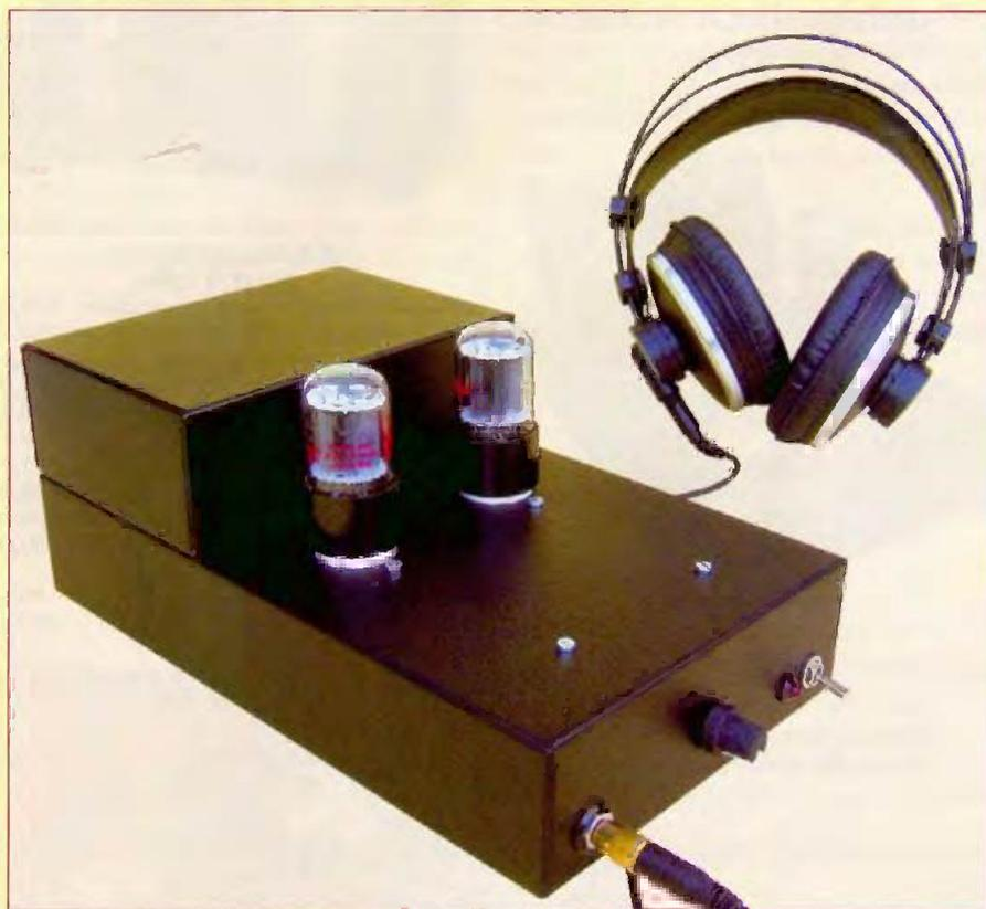
**Cet amplificateur développe une puissance nominale de 100 mW sur 8  $\Omega$  ou 32  $\Omega$ , tout en affichant des spécifications dignes des meilleurs produits. Il met en œuvre un tube 6EM7 d'approvisionnement aisé.**
