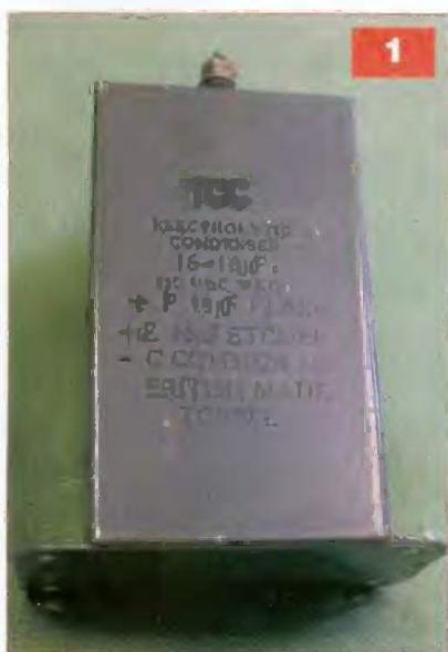
**Contrairement à la légende, les condensateurs de filtrages ne sont pas des condensateurs à bain d'huile, mais de simples électrolytiques carrossés pour le Quad II (c'est écrit dessus !)**
