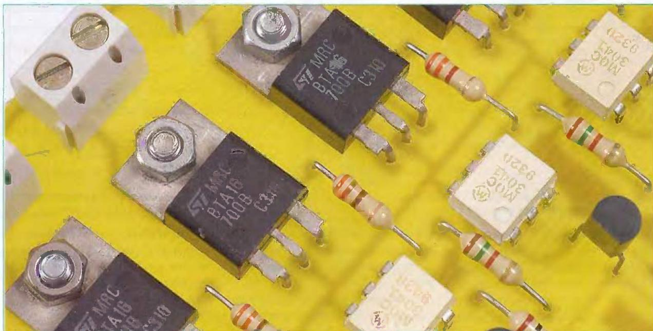
**Les optocoupleurs, également appelés « photocoupleurs », permettent de multiples applications nécessitant une isolation galvanique parfaite entre le circuit de commande et l'étage de sortie. Ils apportent des solutions simples, lorsqu'il s'agit de séparer des masses ou des circuits d'alimentations, d'effectuer des translations de tensions d'alimentations, d'éviter des interférences dues à des boucles de terre, d'isoler les bruits électriques, etc.**
