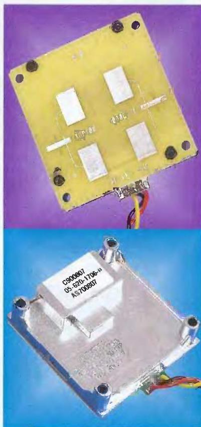
ou autre barrière extérieure (moyennant des précautions d'étanchéité !). Une seconde réalisation, véritable centrale d'alarme, regroupée en un seul circuit intégré, pourra traiter les informations fugitives du détecteur hyperfréquence et constituer un système d'alarme opérationnel avec les traditionnelles temporisations d'entrée et de sortie.
