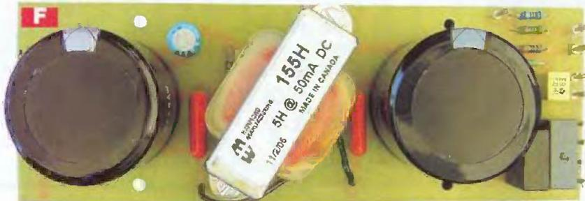
le seul circuit imprimé. Les deux condensateurs de 330  $\mu\text{F}$  ne peuvent pas dépasser une hauteur de 40 mm (figure 12 et photo F).
