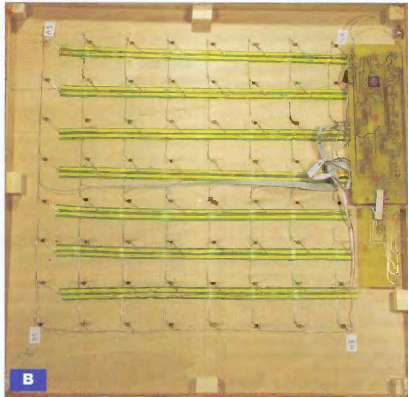
rassembler les pattes en lignes/colonnes pour former une matrice 8 x 8 (figure 10).
