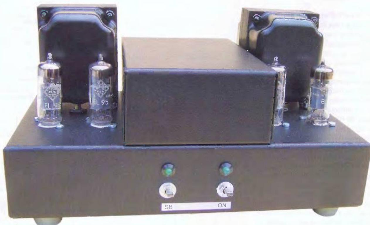
Cet amplificateur met en œuvre un système hybride composé d'un push-pull de EL95 piloté par deux amplificateurs opérationnels OPA604. Il développe une puissance de 2 x 7 Weff, sa bande passante s'étend de 30 Hz à 25 kHz à -1dB. Cette réalisation accepte également un push-pull de EL90, 6AQ5 ou 6005 qui développe 2 x 10 Weff.
