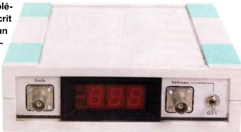
**L**e présent dB-mètre est conçu à partir de composants courants pour en faciliter la réalisation. Il fonctionne en différentiel ou en dBV sur une plage de 94,8 dB théoriques. La résolution et la précision sont de 0,1 dB, cela sur une large plage de mesures. Les méthodes classiques pour le calcul du logarithme d'une tension sont pleines de défauts et nécessitent une tierce méthode.
