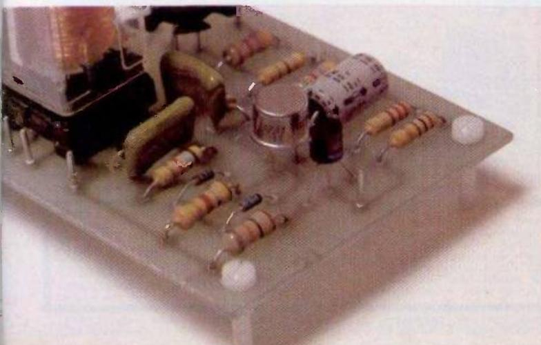
en dernier lieu, notamment le 2N3819. On prendra extrêmement soin de débrancher le fer à souder du réseau de distribution l'instant des dernières soudures afin de ne pas le détruire par un champ parasite trop important (en fait, les nouveaux modèles sont protégés).
