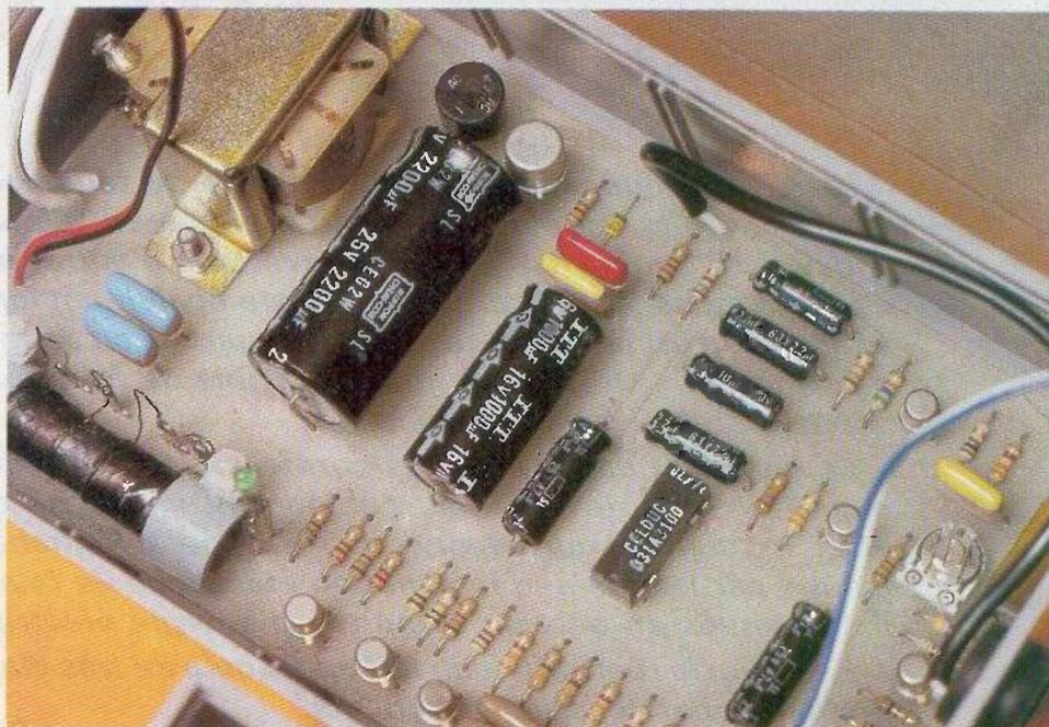
Photo 1. On remarquera l'utilisation d'un transformateur imprégné.
