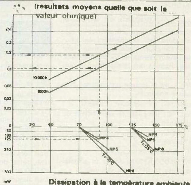
Fig. 7. et 8. - Tenue en fréquence pour trois dissipations : NP4 : 1/4 W, NP5 : 1/2 W, NP6 : 3/4 W. Dérive des résistances à couche métallique en fonction de la température et de la durée de l'essai (SOVCOR).
