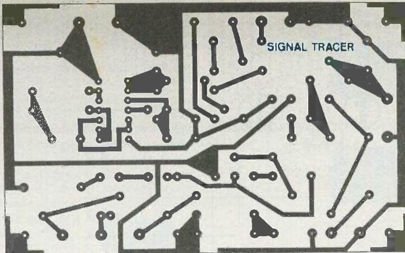
Les bornes d'entrée et de sorties seront, autant que possible, disposées au plus près des emplacements correspondants sur le circuit imprimé. Nous avons étudié ceux-ci, en effet, pour minimiser tous les couplages, sources d'oscillations parasites. Enfin, un interrupteur sera intercalé dans le pôle positif de la pile. Mieux vaut ne pas prévoir de voyant, qui consumerait autant que le montage lui-même.
