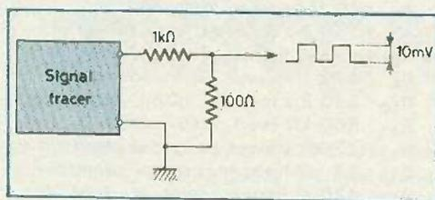
Fig. 6. – Contrôle du signal-tracer par lui-même.
