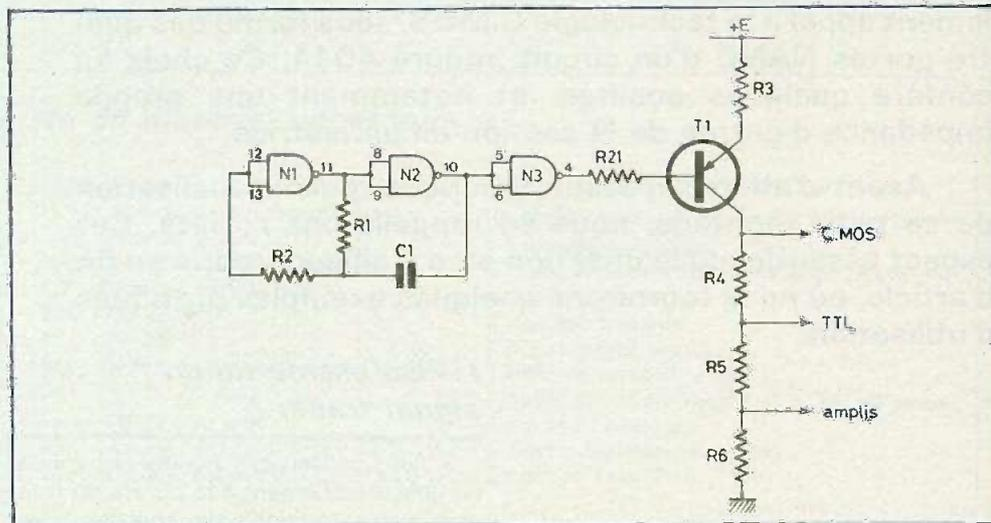
Fig. 2. - Les deux NAND  $N_1$ ,  $N_2$ , réalisent un multivibrateur astable, tandis que  $N_3$  assure la mise en forme des signaux obtenus.
