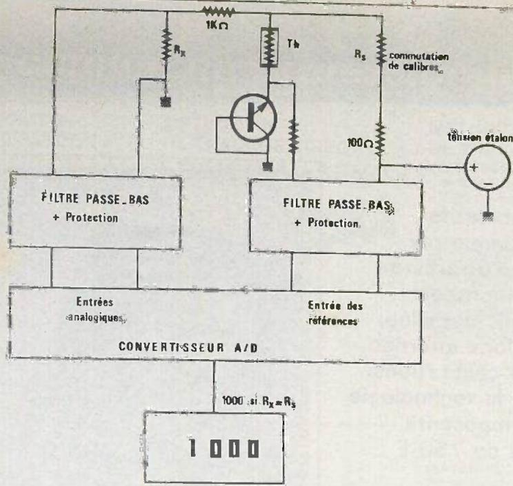
Fig. 1. - La partie ohmmètre : une tension de référence débite dans une résistance inconnue. Un convertisseur A/D effectue une mesure de tension différentielle.
