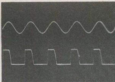
**Photo D.** – Trace supérieure : signal d'entrée sinusoïdal. Trace inférieure : tension de sortie, signal écriété à cause du grand gain de l'ampli
