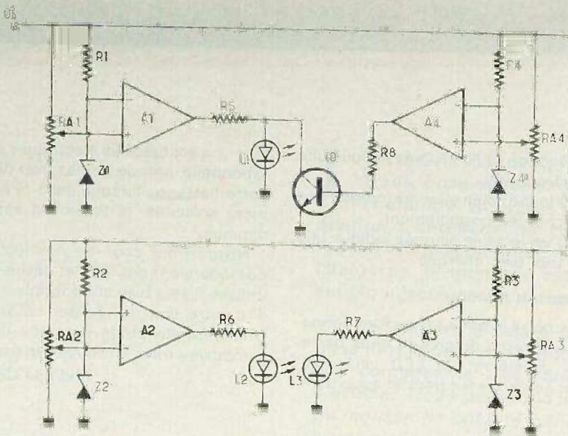
sortie passe à 0 V, la LED rouge s'éteint donc. A<sub>1</sub>, A<sub>3</sub> et A<sub>4</sub> ne bougent pas. La LED jaune est donc seule allumée.
