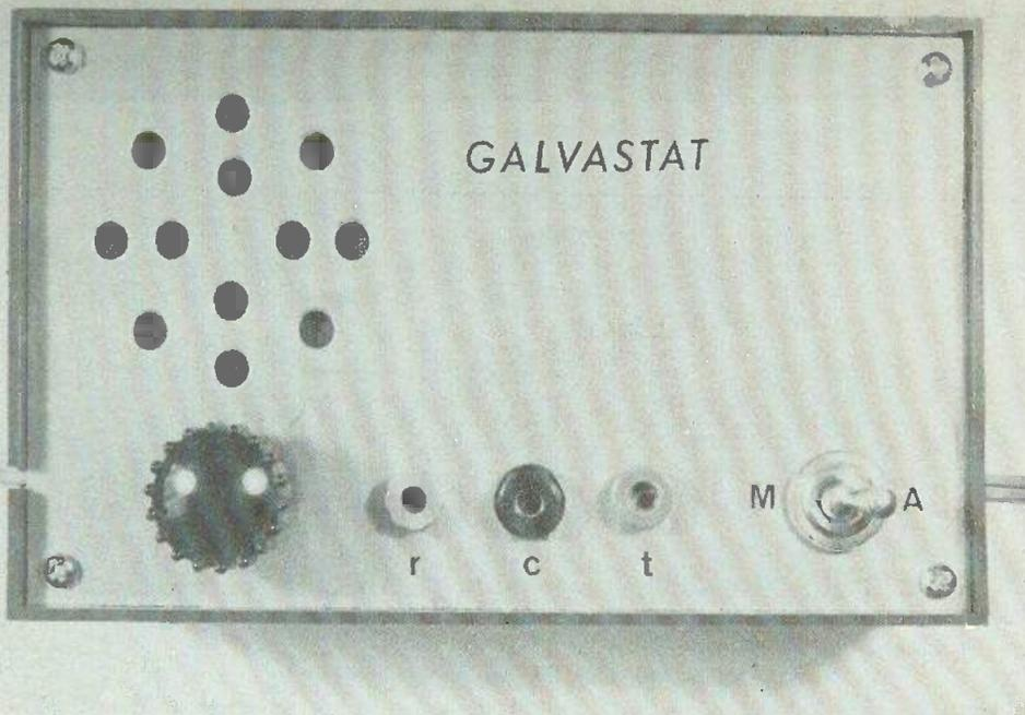
Photo 7. – Face avant rationnelle : les fiches « utilisation » présente un écartement normalisé à 19 mm.
