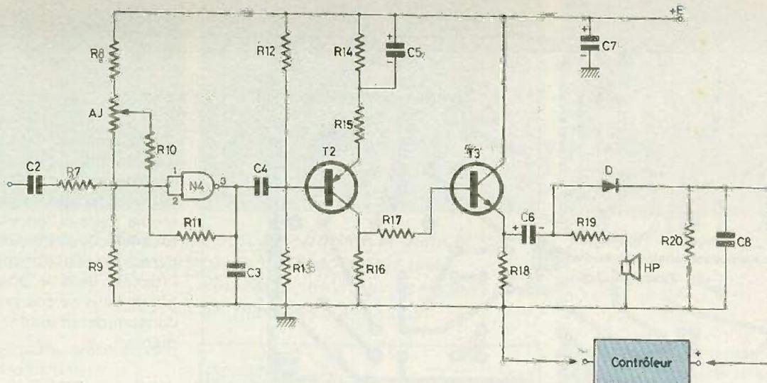
Fig. 3. – La section amplificatrice :  $N_4$  constitue ici un ampli linéaire.  $T_2$  amplifie en tension et  $T_3$  en puissance. Deux éléments permettent le contrôle du niveau de sortie : un haut-parleur et un galvanomètre.
