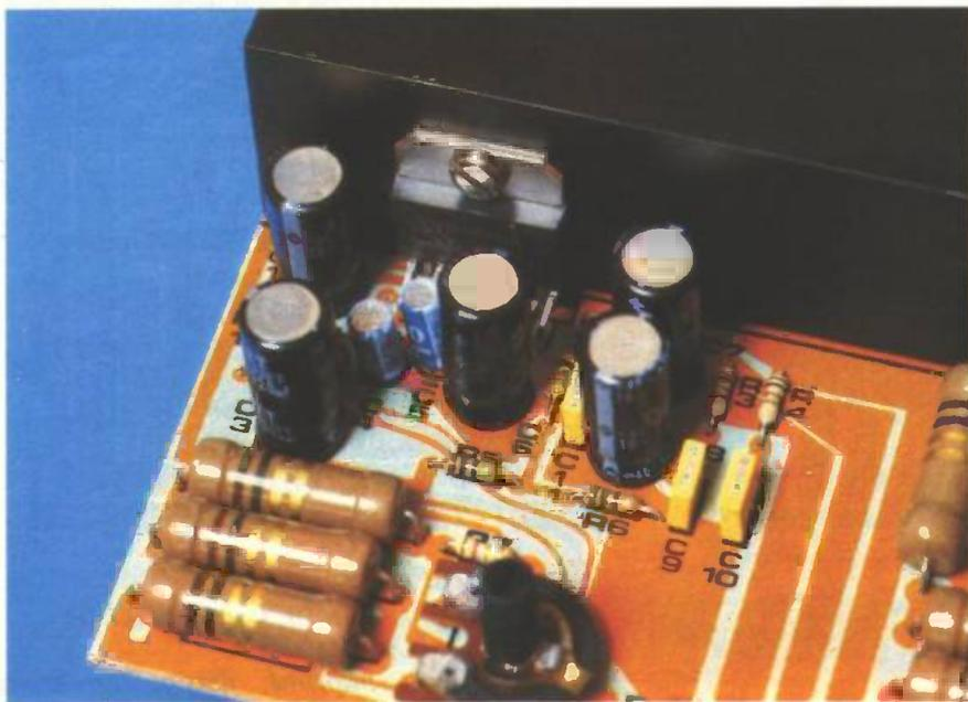
Il faudra bien fixer la languette de refroidissement du circuit intégré au dissipateur.
