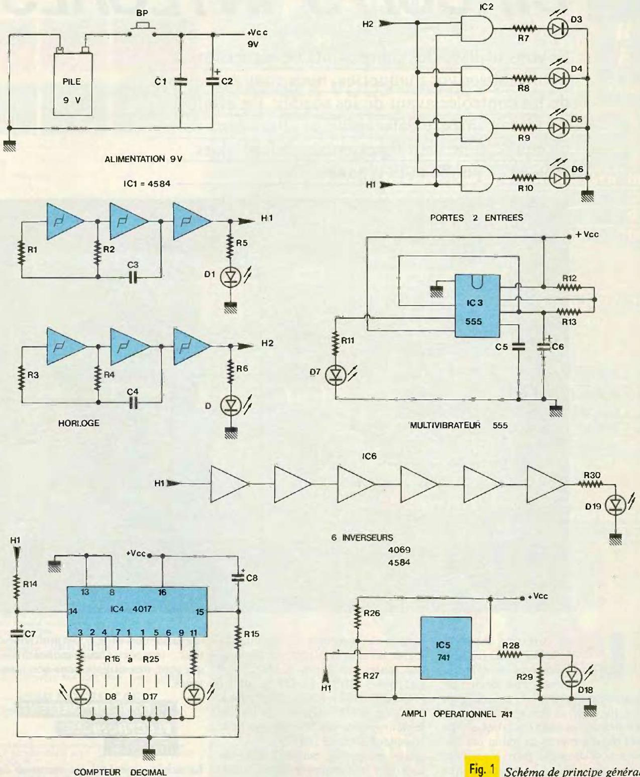
Fig. 1 Schéma de principe général.
