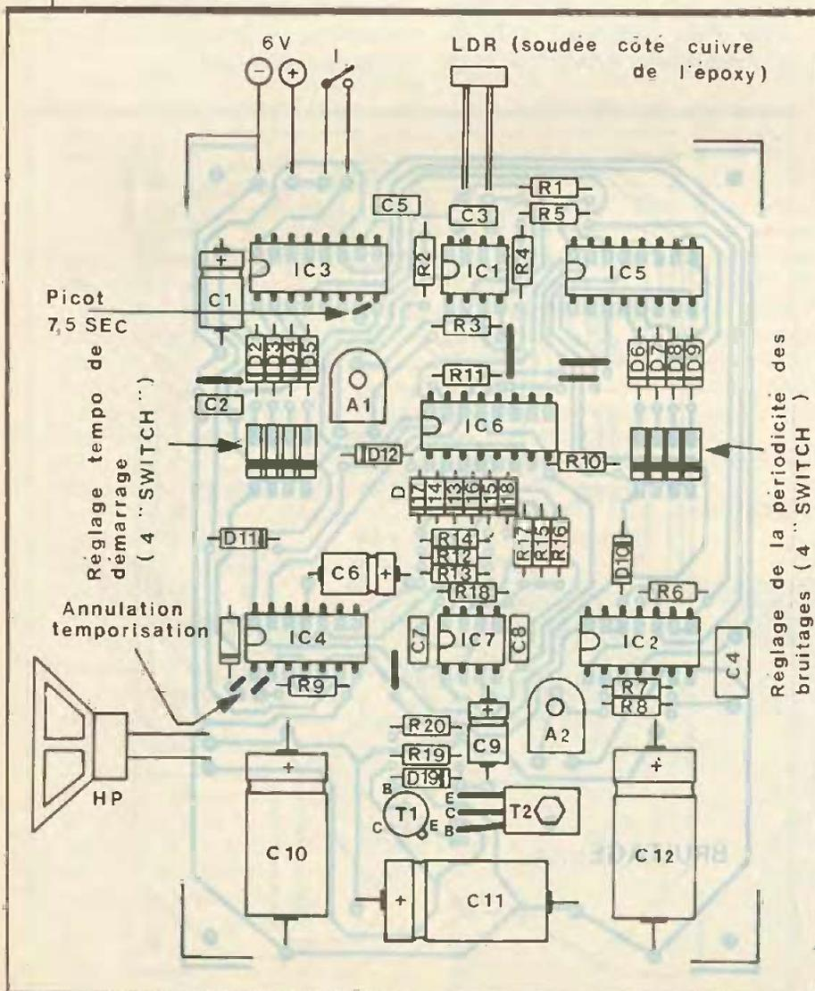
Fig. 6 et 7 - Tracé du circuit et implantation des éléments.
