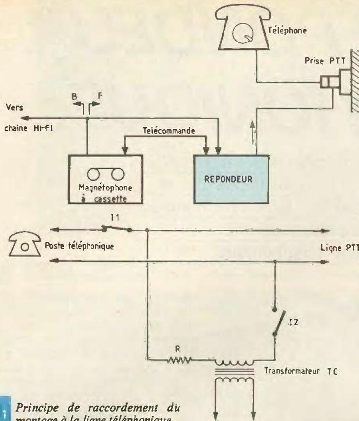
Fig. 1 Principe de raccordement du montage à la ligne téléphonique
