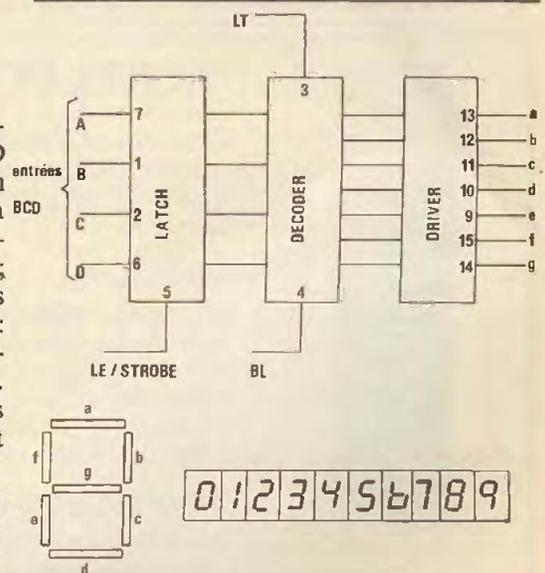
Fig. 2 Diagramme fonctionnel.
