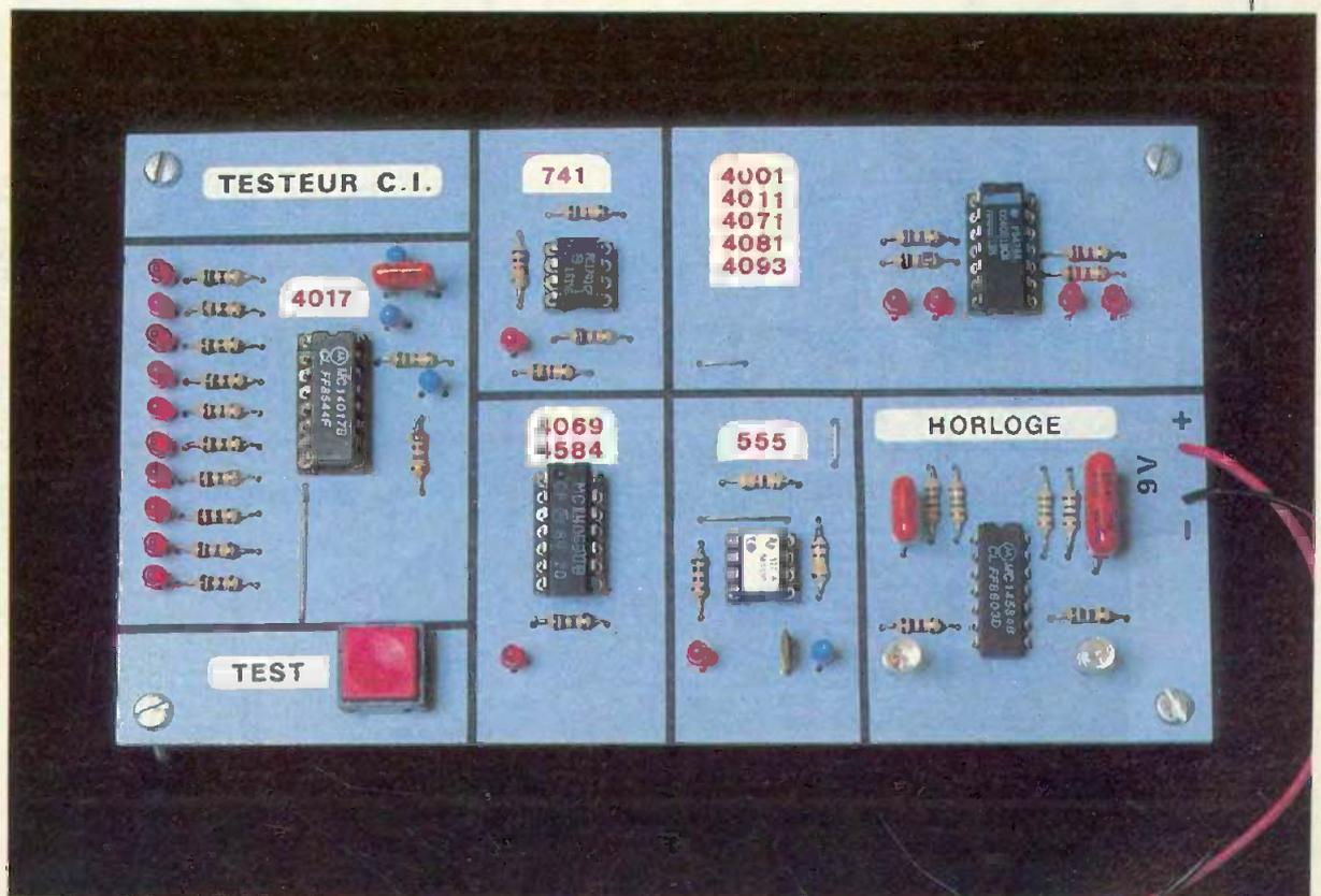
Les circuits intégrés C.MOS sont particulièrement « allergiques » aux décharges électrostatiques, c'est pourquoi ils sont livrés dans des emballages ou sur des mousses antistatiques. Le port de vêtements en nylon est fortement déconseillé pour manipuler ces composants. La maquette que nous vous proposons aujourd'hui
