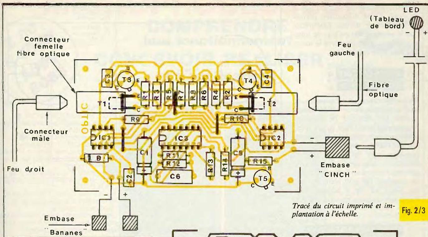
Remarquons qu'au moment de l'établissement de la tension d'alimentation, la capacité  $C_5$  se charge à travers  $R_{13}$ . Il en résulte, dans un premier temps, un état assimilable à un niveau logique 1 sur l'entrée 6 de la porte II qui, de ce fait, passe momentanément à un état bas sur sa sortie, ce qui se traduit par un état haut à la sortie de la porte III. Il en résulte l'allumage, pendant quelques secondes, de la LED de
