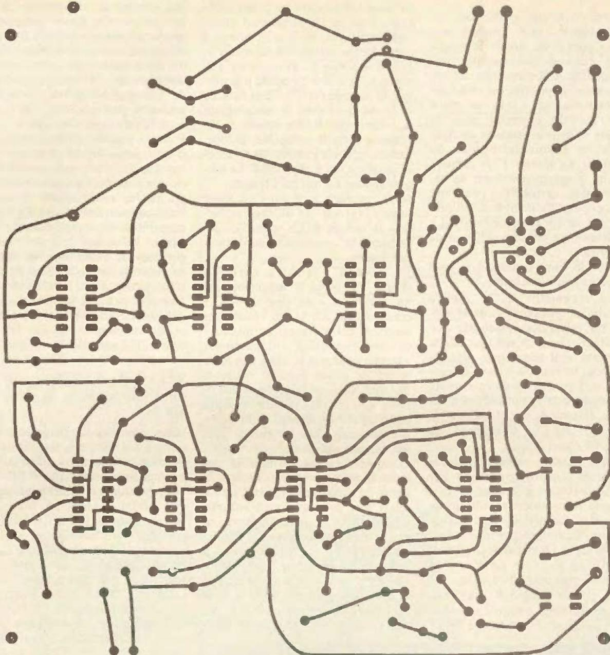
**Fig. 7** *Tracé du circuit imprimé grandeur nature.*
