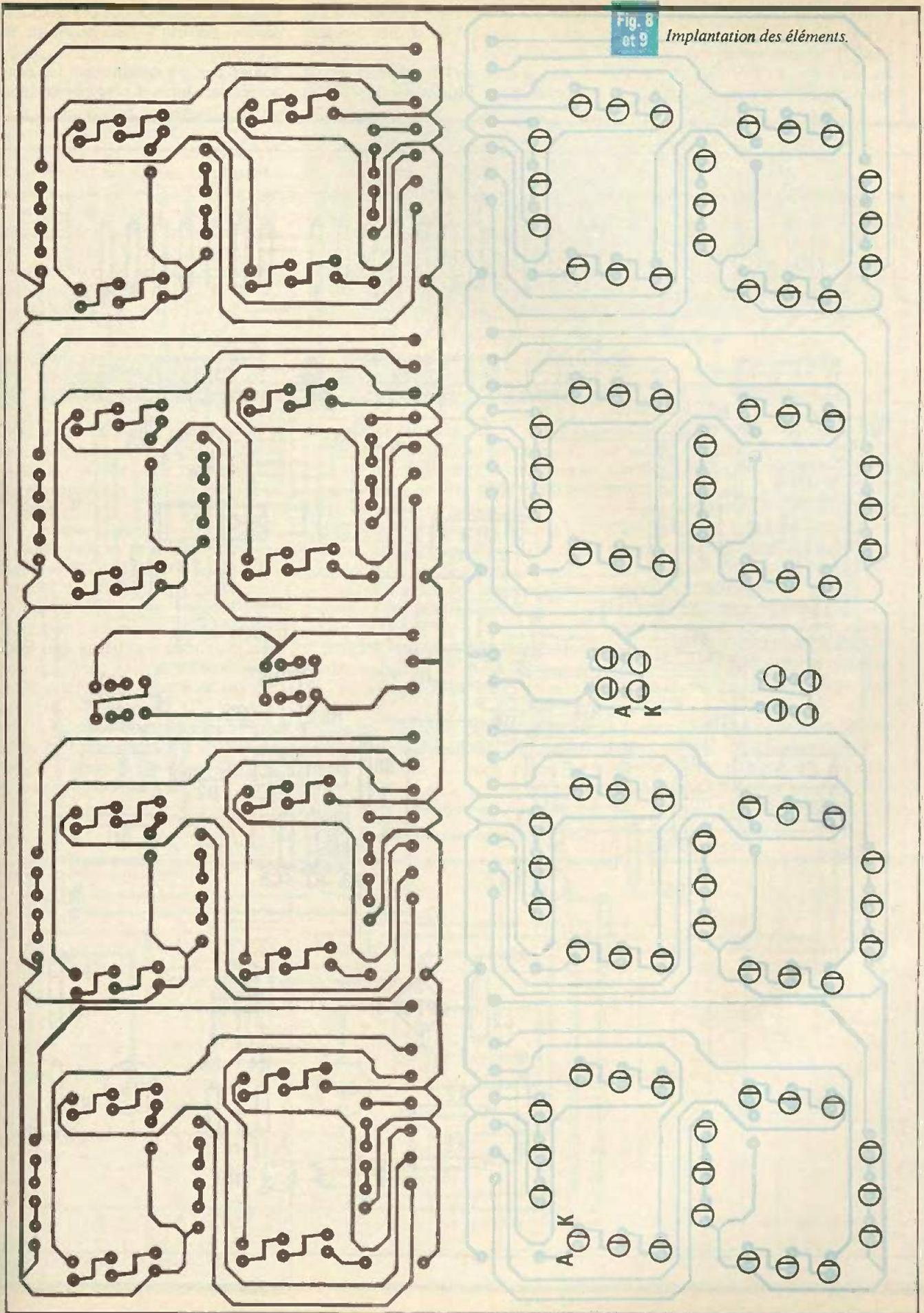
Pour commencer, on montera les straps. Ils sont au nombre de 27, on soudera ensuite les résistances, puis les condensateurs. C<sub>3</sub> et C<sub>5</sub> seront des modèles radiaux.
