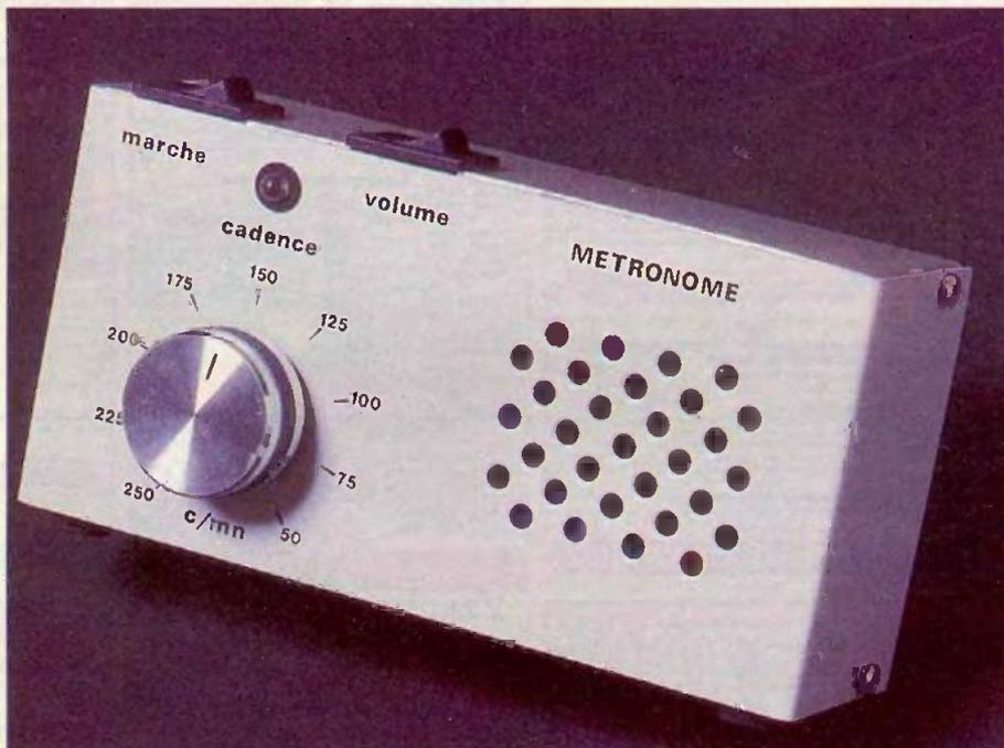
**L**a cadence est réglable de 40 à 260 coups par minute environ. Elle est visualisée par une LED qui émet un flash à chaque battement. Le niveau sonore agréable est programmable sur deux positions : normal ou atténué. La consommation est faible.
