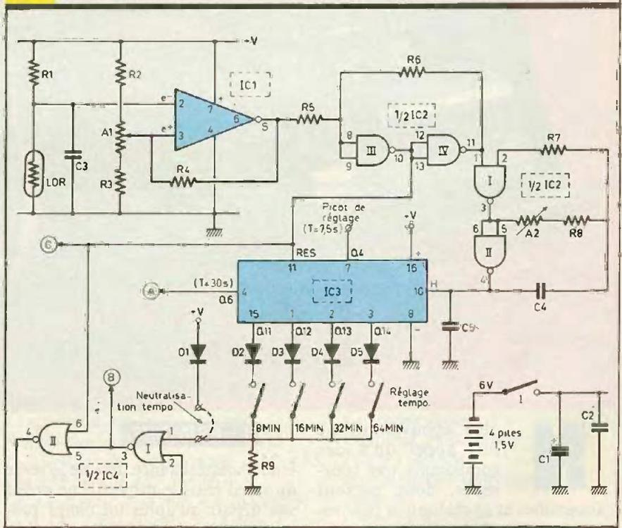
la pile du montage en conférant à ce dernier une meilleure stabilité de fonctionnement. Un interrupteur I permet d'arrêter l'alimentation à tout moment.
