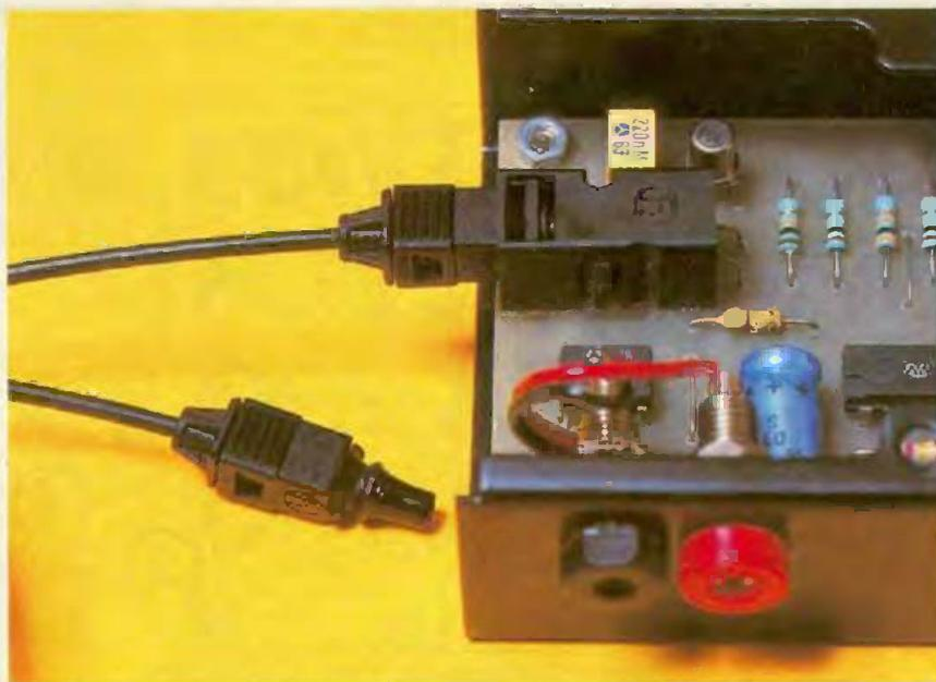
Photo 2. — On aperçoit les connecteurs optiques.
