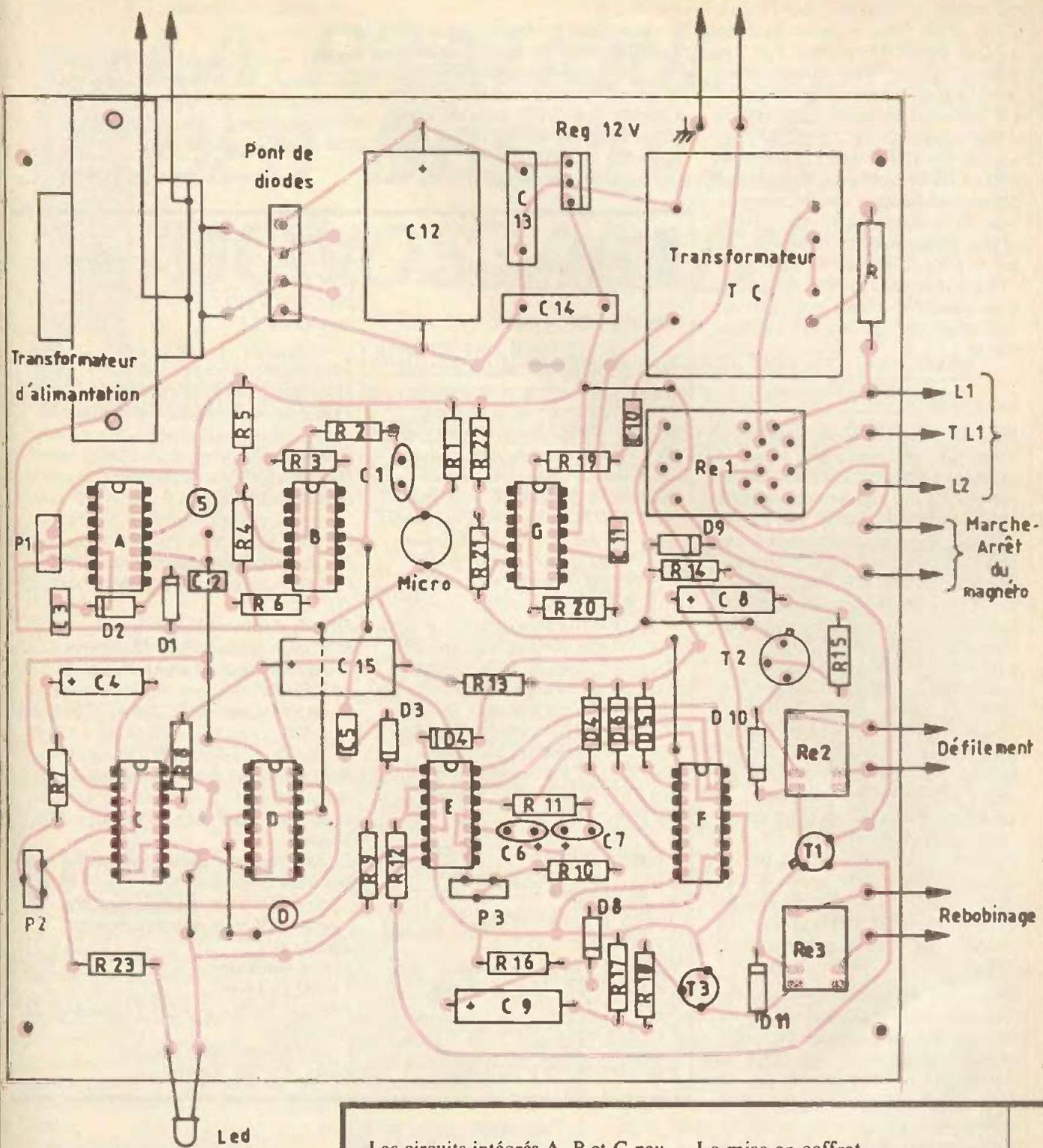
Fig. 8 Implantation des éléments.
