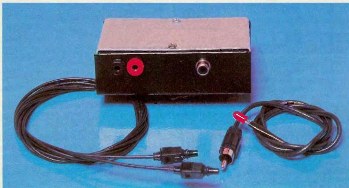
signalisation installée sur le tableau de bord. Cette disposition permet au conducteur d'avoir l'assurance que le montage est en état de fonctionnement et lui signalera le moindre défaut, le cas échéant.
