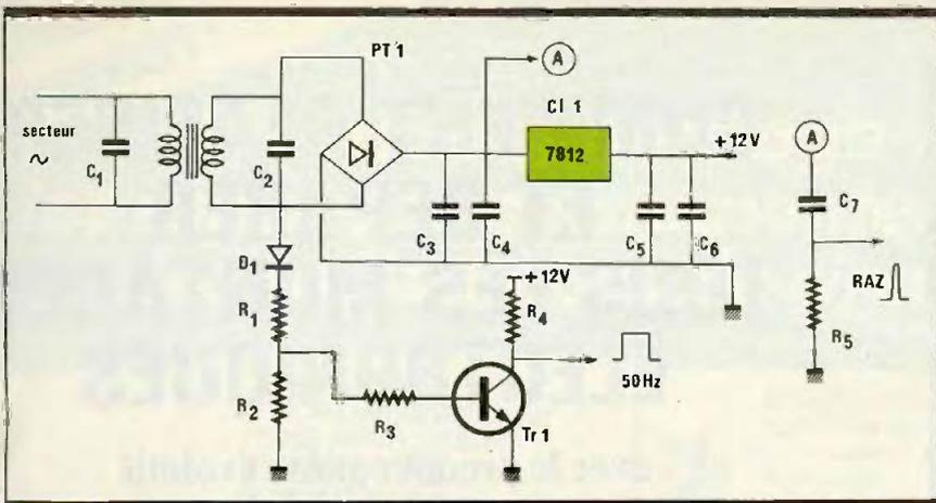
Fig. 1 Alimentation et mise en forme du signal.
