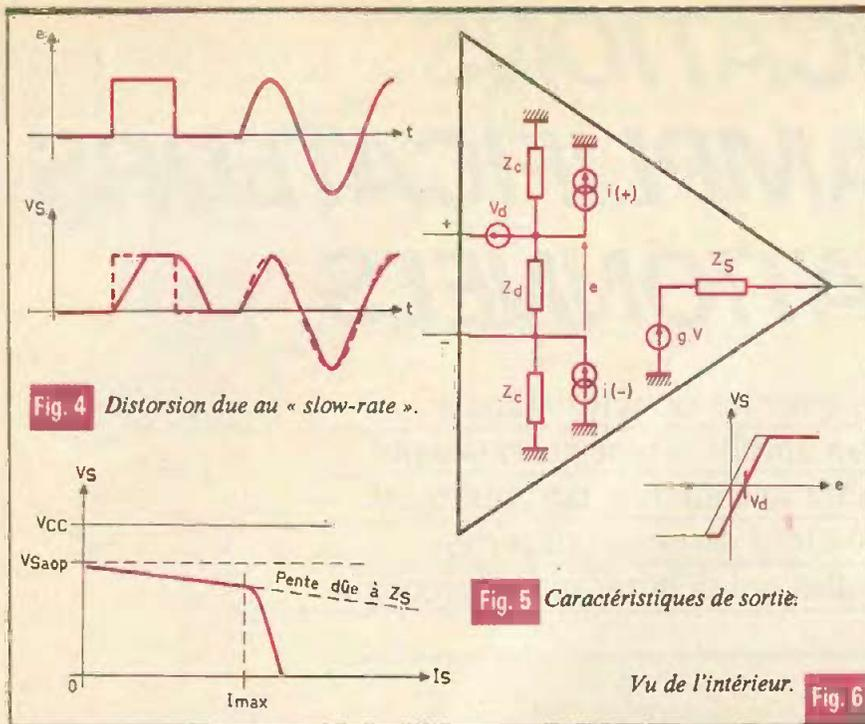
Fig. 4 Distorsion due au « slow-rate ».
