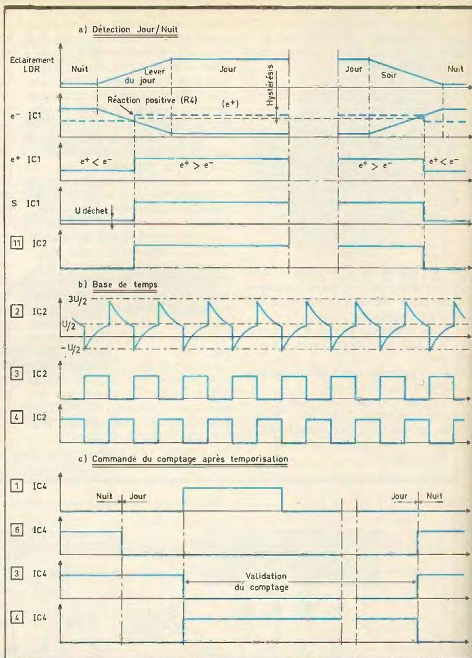
Fig. 4 - Oscillogrammes caractéristiques.
