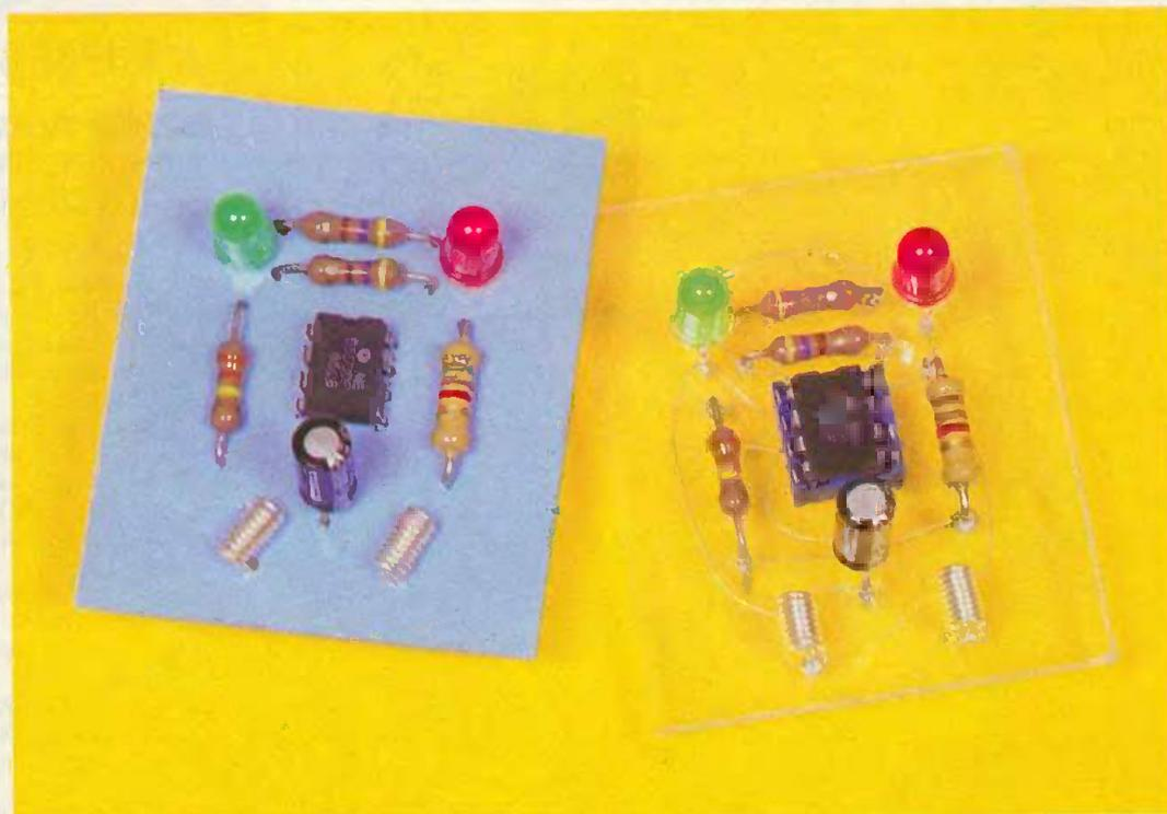
**L'**avantage du Circuigraph repose sur la réalisation quasi instantanée d'un montage à l'aide d'un support isolant quelconque, tel que carton, bristol, plastique, plexiglas, etc.
