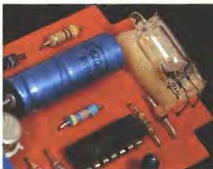
Photo 4. - Gros plan sur le contacteur mercure.
