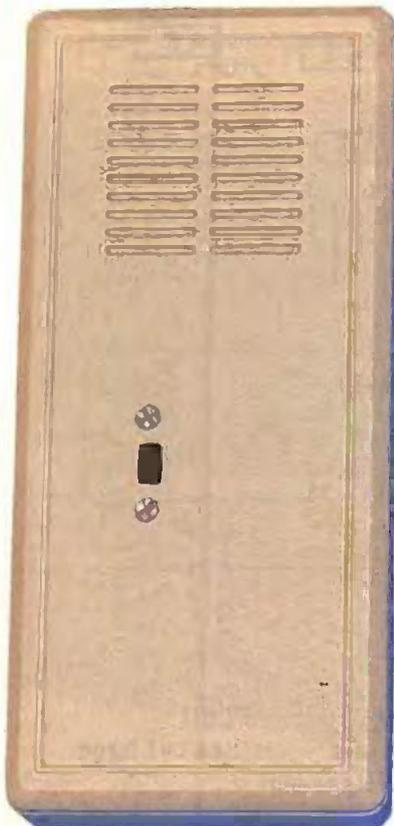
(2 trous  $\varnothing$  10 mm pour les passe-fils, et 2 trous  $\varnothing$  8 mm pour les fiches banane). Terminer par une série de trous de  $\varnothing$  3,2 mm dans le fond du boîtier. Ils seront utilisés pour la fixation du circuit imprimé et des deux transformateurs.
