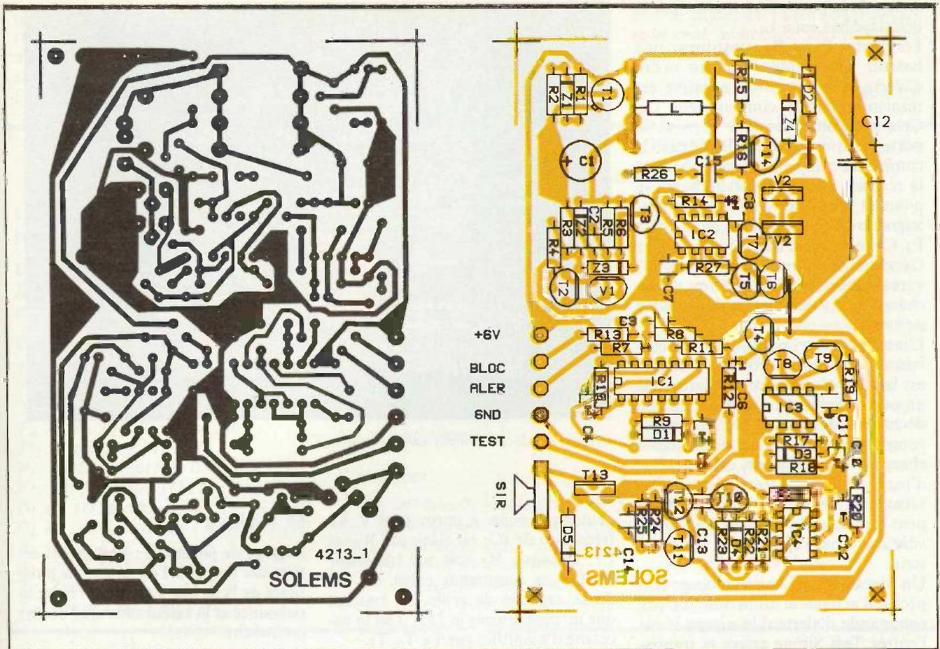
**Fig. 2** Tracé du circuit imprimé à l'échelle et implantation des éléments.
