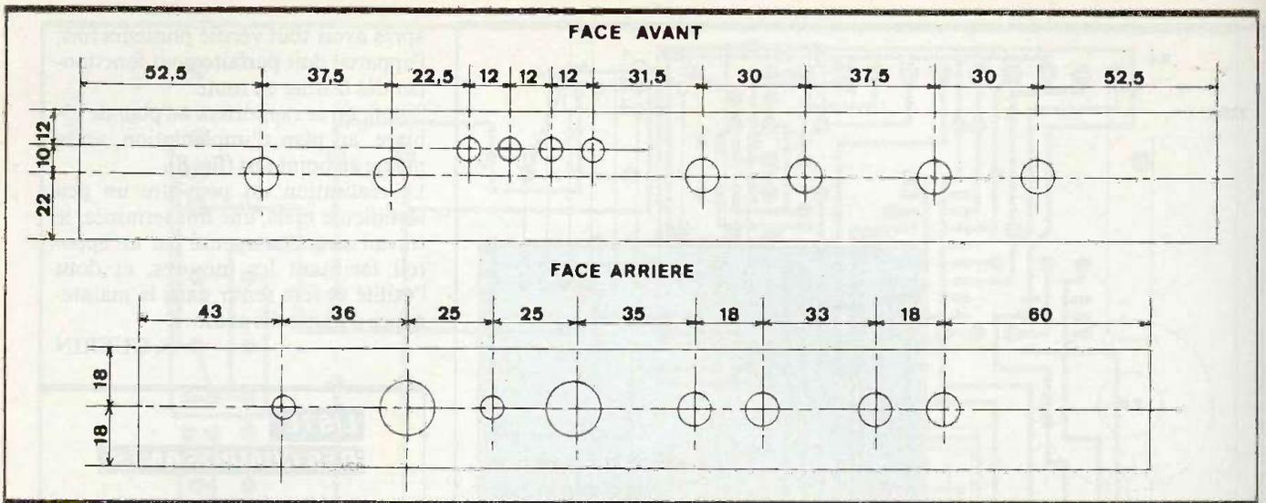
Fig. 8 Plan de tôle.
