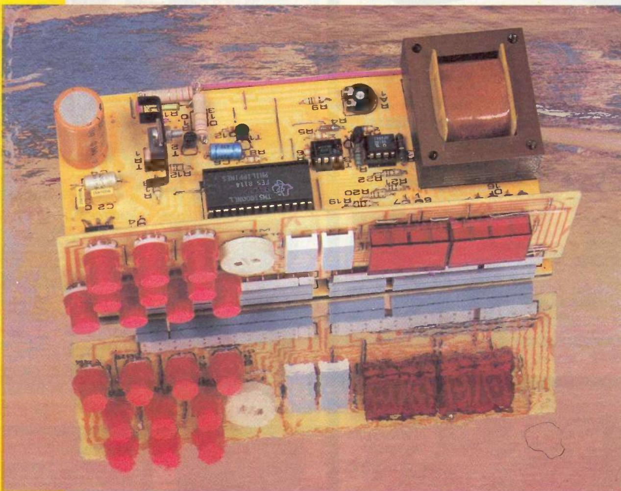
**E**n effet, à l'aide de ce précieux montage vous pourrez programmer la température désirée, à l'heure voulue. L'ensemble commande une charge (non selfique) jusqu'à concurrence de 1 200 W. Bien sûr moyennant quelques modifications triac de sortie et dissipateur
