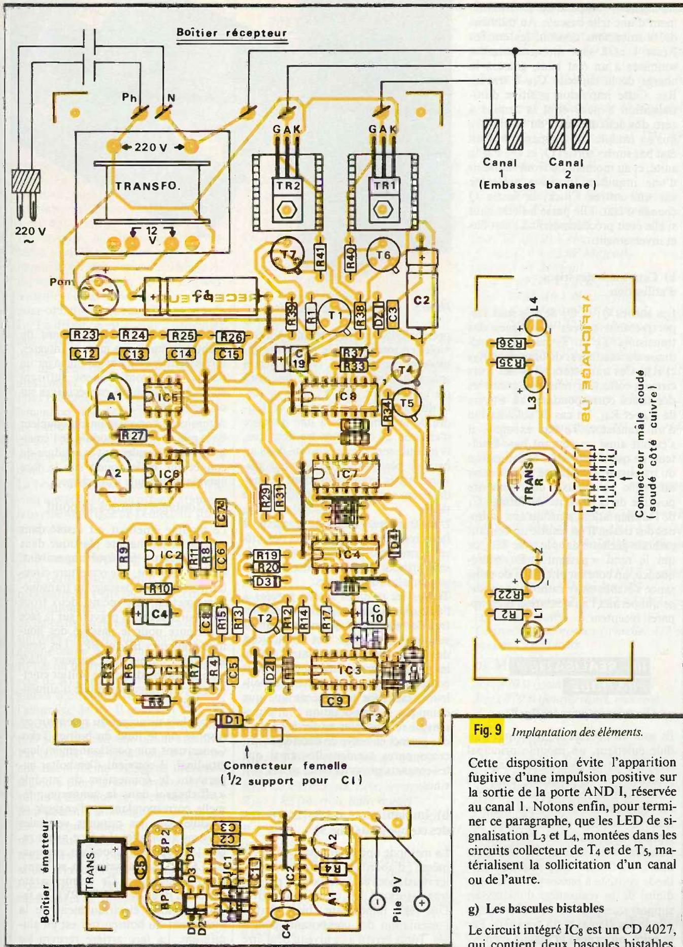
**Fig. 9** Implantation des éléments.
