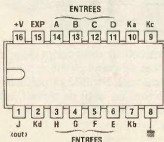
A, B, C, D, E, F, G et H, recevant les niveaux logiques à traiter sous forme de fonction. Une entrée « EXPAND » a son utilité en cas d'extension du nombre d'entrées. Trois entrées  $K_a$ ,  $K_b$  et  $K_c$  constituent la commande, sous la forme d'une information binaire, de la fonction souhaitée. Enfin, une entrée  $K_d$  permet la réalisation du découplage de la sortie unique J avec le circuit intégré.
