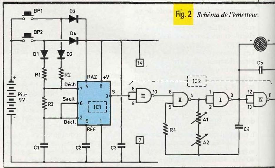
Fig. 2 Schéma de l'émetteur.
