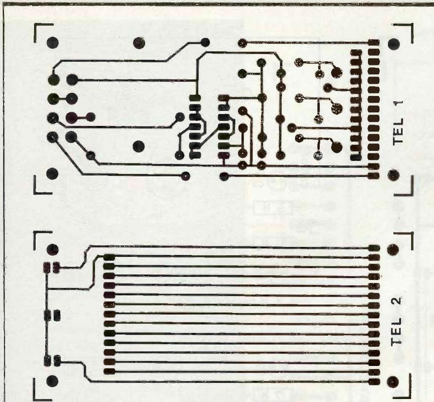
Détails de réalisation à l'échelle des circuits inférieur et supérieur. **Fig. 4 et 5**
