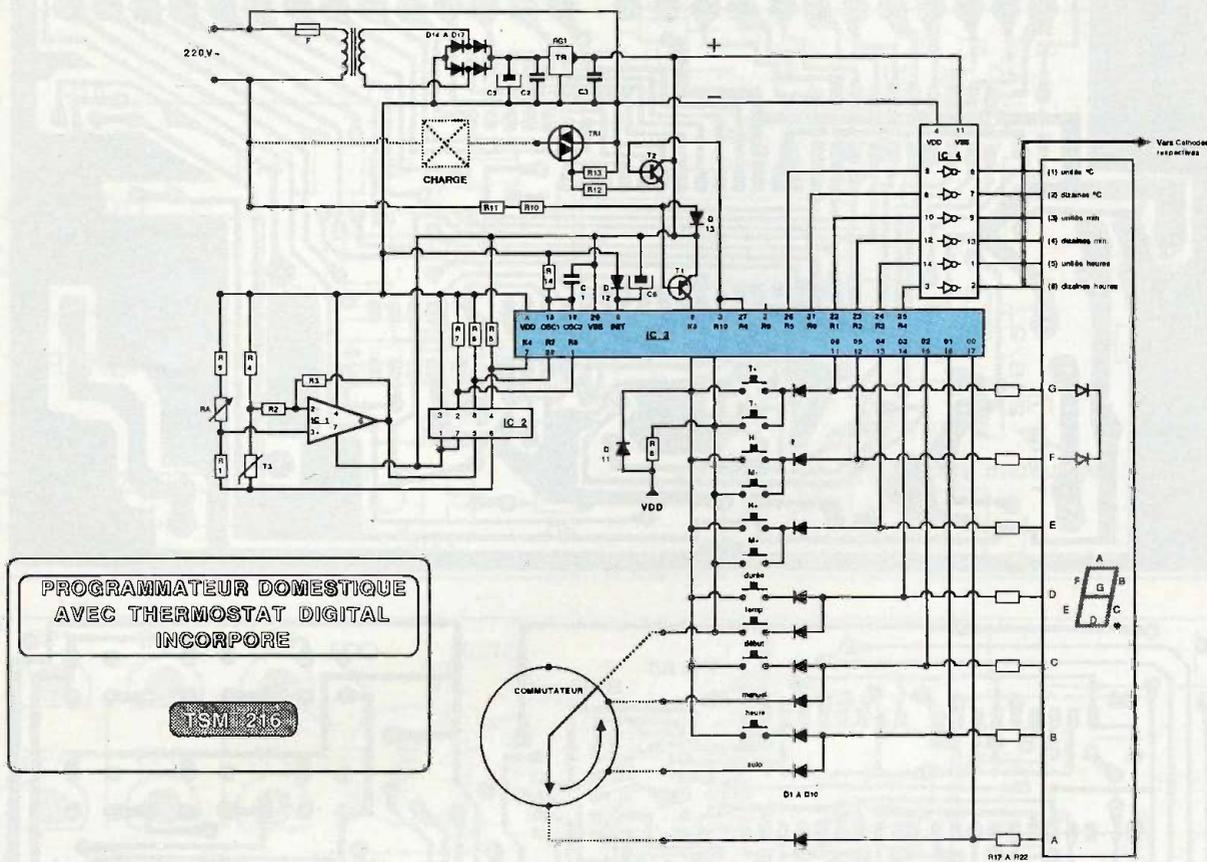
Fig. 1 Schéma de principe complet du TSM 216.
