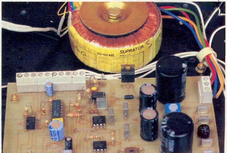
Photo 4. - Utilisation d'un transformateur torique.
