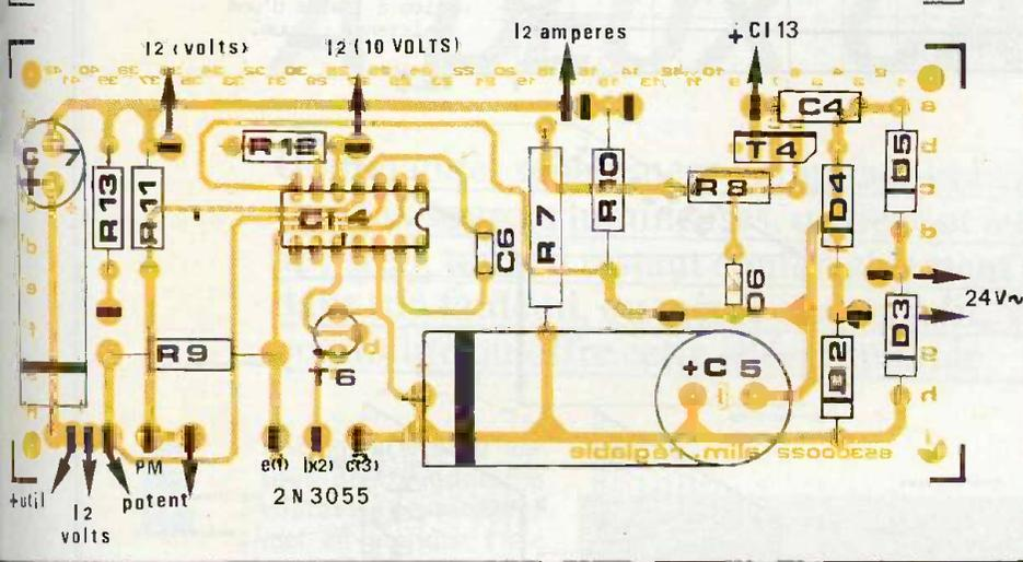
tion contraire. Le câblage est effectué dans l'ordre indiqué par les tableaux joints en annexe. Toutefois, nous vous conseillons de monter le commutateur et les interrupteurs en dernier afin de ne pas être gêné par les fils de liaison pendant l'assemblage. De même, par mesure de sécurité, les circuits intégrés ne seront insérés dans leurs supports qu'à la fin du câblage.
