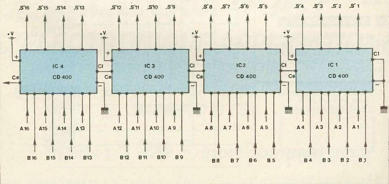
La figure 4 indique également l'écriture binaire du nombre B (26 341). En appliquant la table de vérité, étage par étage, on obtient le nombre binaire  $S_1, S_2, \dots, S_{16}$ , qui représente l'addition de A et de B ; cette opération a été résumée dans le tableau contigu au schéma de la figure 4. En vérifiant le résultat obtenu et en le
