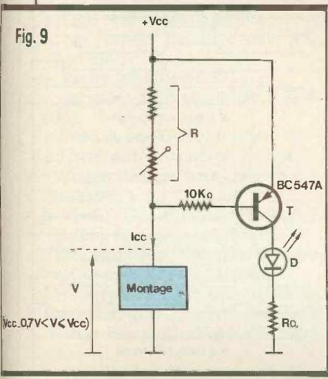
dépasse cette limite, T conduit et illumine la DEL.  $R_D$  sera définie selon  $V_{cc}$ , environ  $V_{cc}/10$  mA. En utilisant pour R une résistance talon et un potentiomètre gradué, on réalise un mini-ampèremètre. Au moment de l'allumage de la DEL, on a  $I_{cc}$  égal à la graduation du potentiomètre. Sinon, avec une résistance fixe, ce dispositif sera utile, en sortie d'une alimentation, pour indiquer un dépassement...
