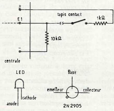
**Fig. 17** Exemple de raccordement de la centrale.
