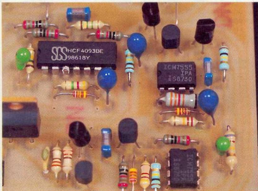
qui agit sur le bloc de commande au niveau d'une entrée de la borne 13 de IC<sub>1</sub>. Lorsque la tension batterie est supérieure à 6 V, la Zener Z<sub>2</sub> devient passante, ce qui rend le transistor T<sub>2</sub> passant. La Zener Z<sub>3</sub> se trouve ainsi appliquée au + batterie par l'intermédiaire du transistor T<sub>5</sub> saturé et contribue ainsi à maintenir T<sub>2</sub> saturé. Il s'ensuit que le niveau logique émis est 1.
