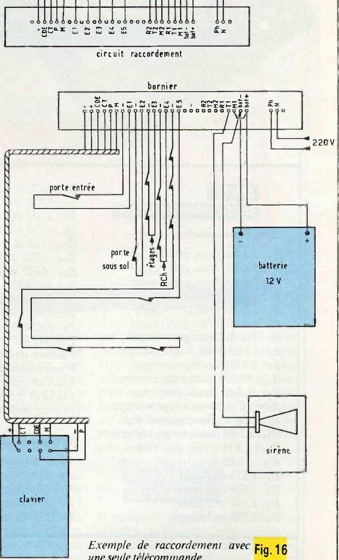
Exemple de raccordement avec une seule télécommande. **Fig. 16**
