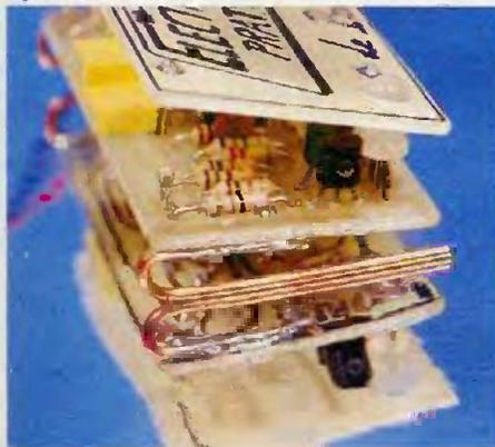
En figure 7, un cache qui pourra être réalisé en époxy, comme un circuit imprimé, pour préciser l'intitulé. Il se fixera sur le circuit principal par des cosses support tulipe. Il pourra le cas échéant jouer le rôle d'interrupteur de mise sous tension, bien que le plus simple soit de déconnecter la pile.
