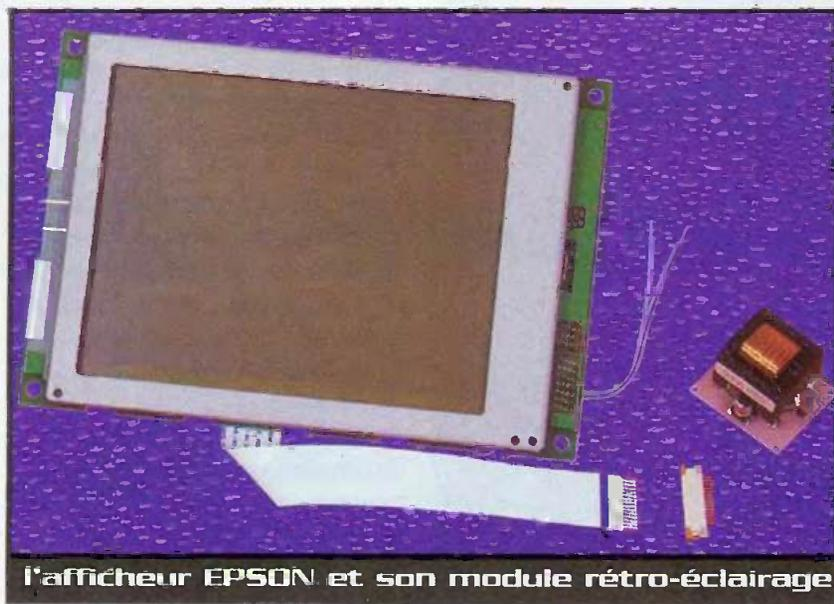
l'afficheur EPSON et son module rétro-éclairage
