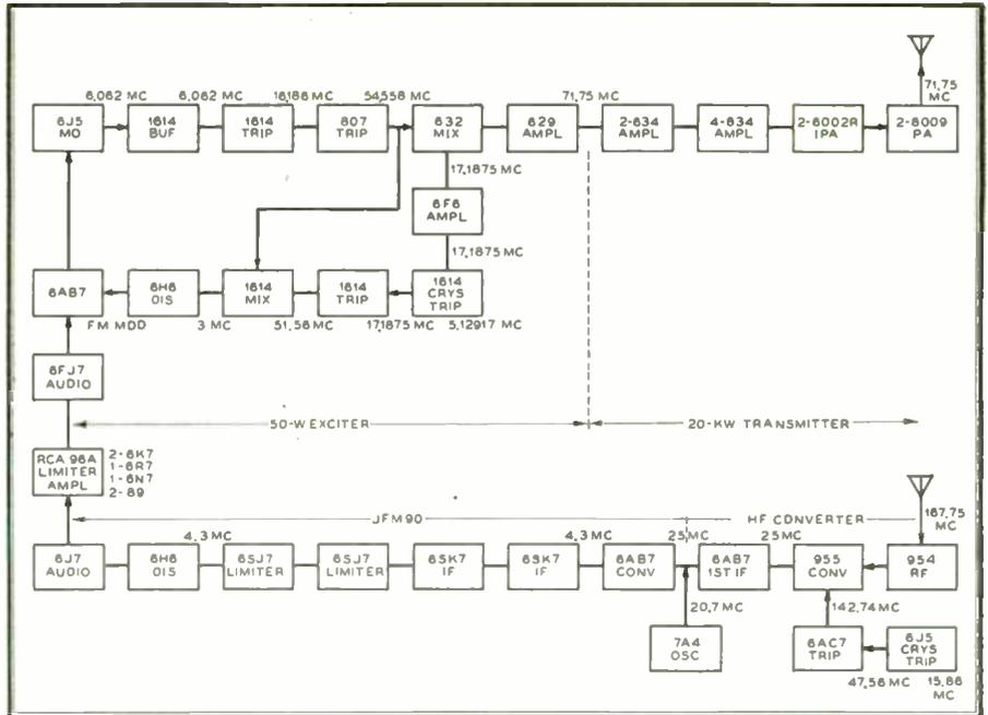
FIG. 34. SOUND RECEIVER WHICH FEEDS THE 20-KW. SOUND TRANSMITTER
