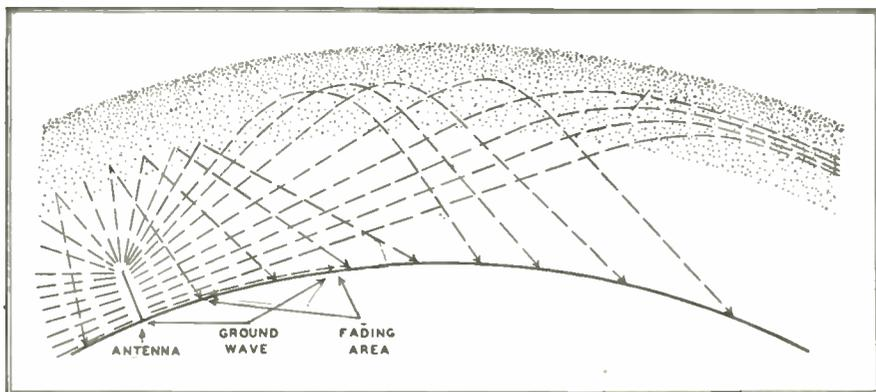
FIG. 6. LEFT: AM BROADCAST TRANSMISSION DURING DAYLIGHT HOURS IS BY MEANS OF THE GROUND WAVE. SKYWARD TRANSMISSION IS ABSORBED IN REGION BELOW  $E$  LAYER. RIGHT: AT NIGHT, SKYWAVES, RETURNED TO EARTH, GIVE LONG-DISTANCE COVERAGE, BUT CAUSE FADING IN THE OUTER PORTION OF THE AREA REACHED BY THE GROUND WAVE
