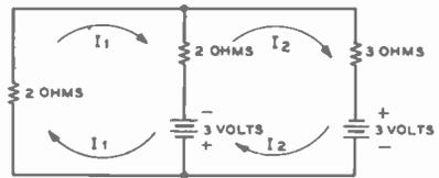
1. SET VOLTAGE DROPS AROUND EACH LOOP EQUAL TO ZERO.
