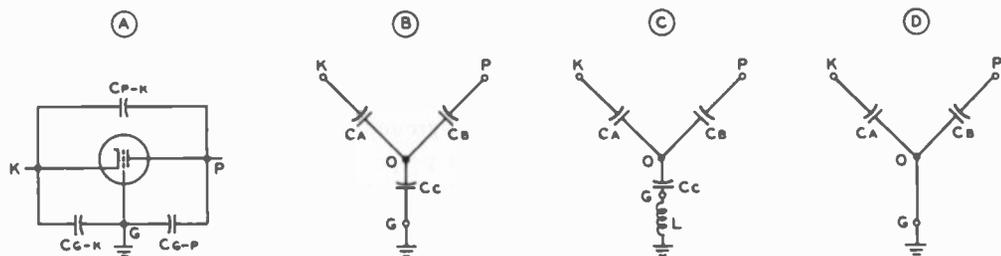
$$C_c = \frac{(C_{P-G} \times C_{P-K}) \pm (C_{P-K} \times C_{G-K}) \pm (C_{G-K} \times C_{P-G})}{C_{P-K}}$$
