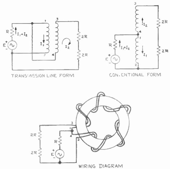
Fig. 3—4:1 Impedance transformer.
