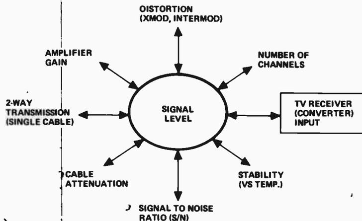
**CABLE SYSTEM SIGNAL LEVEL-CABLE
