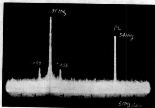
Photo 5 REVERSE BAND FREQUENCY SPECTRUM
