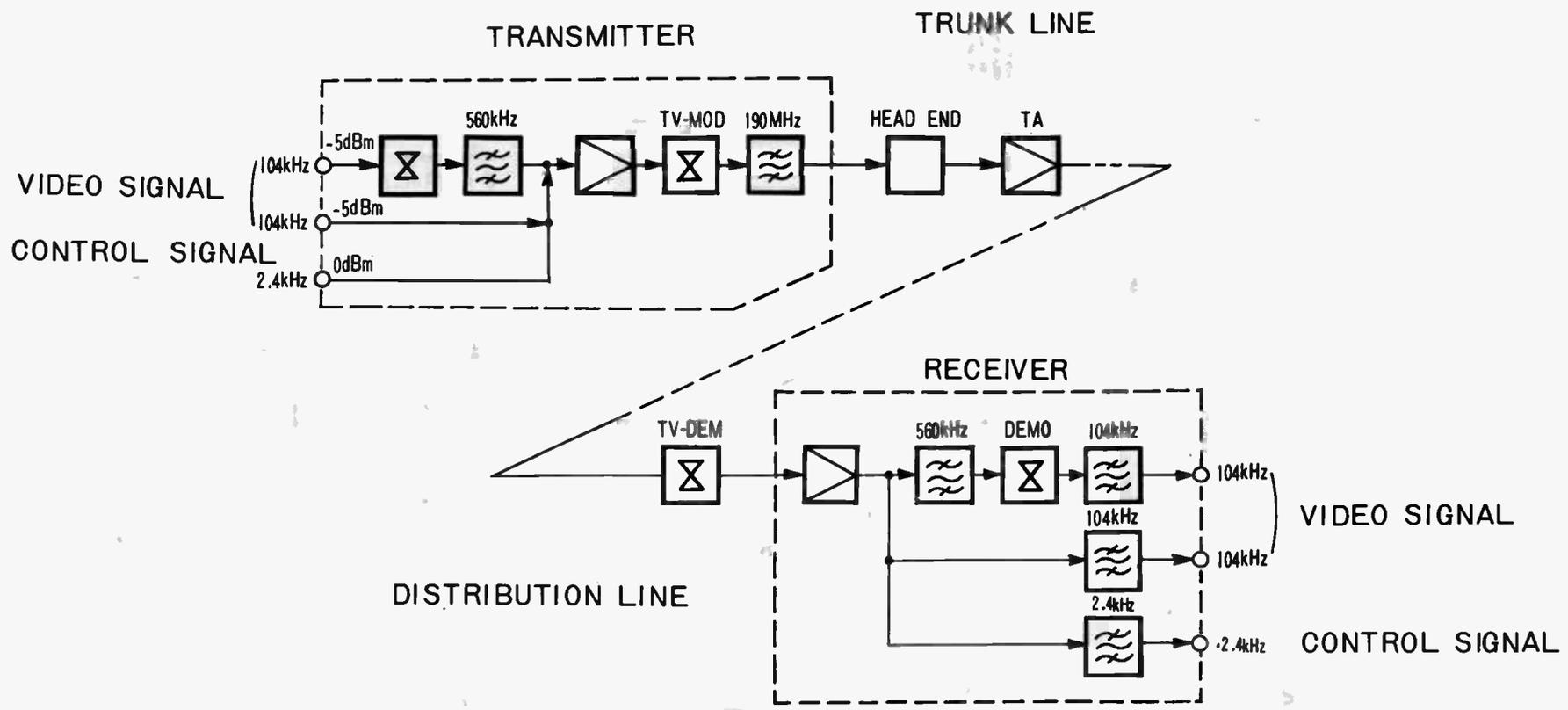
Fig. 5 CATV-FACSIMILE TRANSMISSION SYSTEM CONFIGURATION
