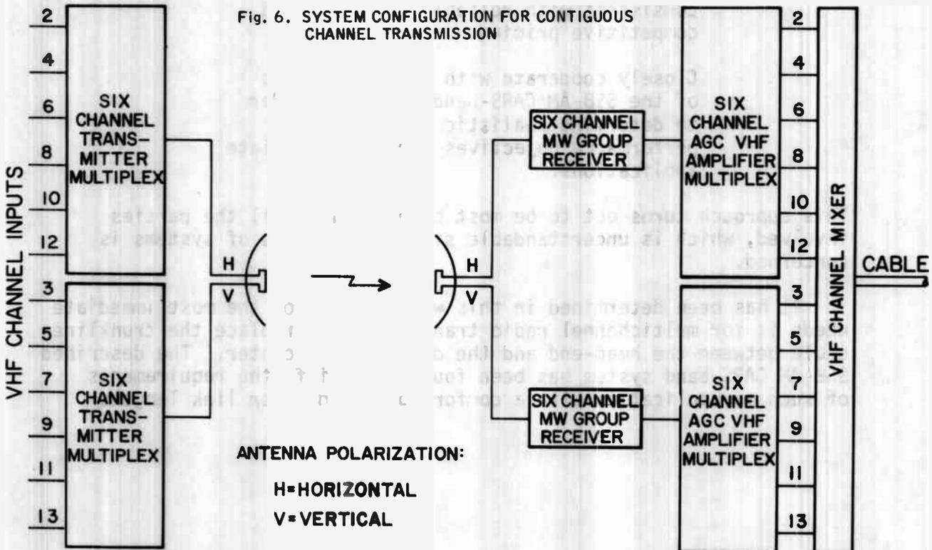
Fig. 6. SYSTEM CONFIGURATION FOR CONTIGUOUS CHANNEL TRANSMISSION
