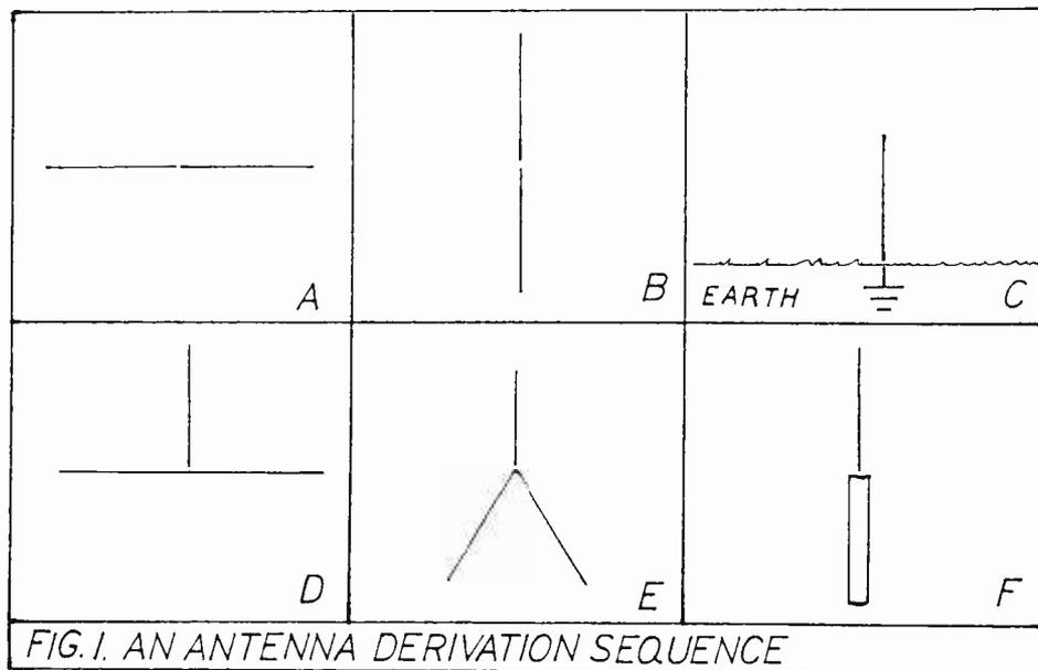
FIG. 1. AN ANTENNA DERIVATION SEQUENCE
