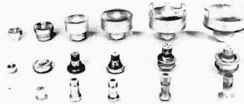
Fig. 36. Cermolox tubes (RCA).
