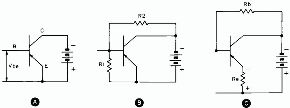
FIG. 9. Transistor bias.
