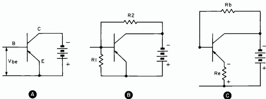
FIG. 9. Transistor bias.
