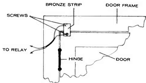
Fig. 6. Simple door switch.
