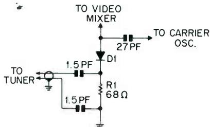
Fig. 17. Diode modulator.
