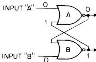
Fig. 11. Set-reset flip-flop.
