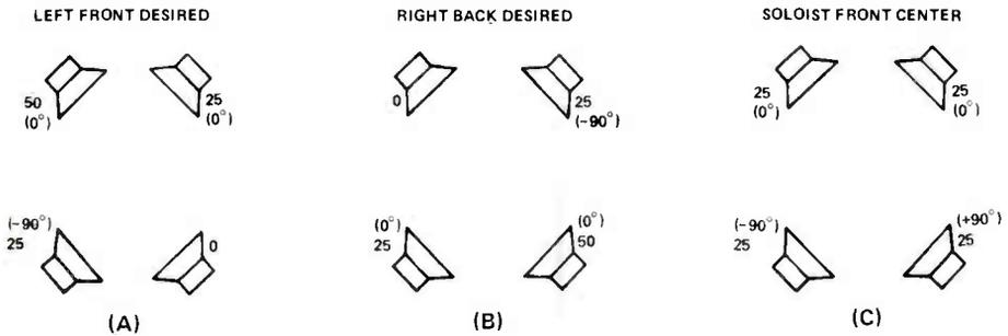
FIGURE 3. POWER AND PHASE DISTRIBUTION FOR THE SANSUI QS DECODER.
