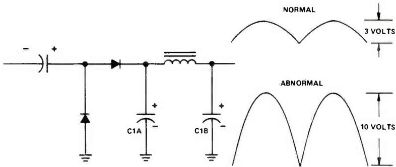
FIGURE 4. POWER SUPPLY OUTPUT WAVEFORMS.
