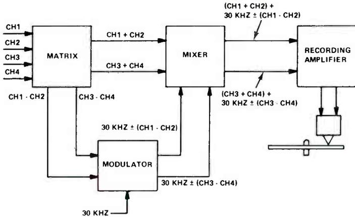
FIGURE 7. FOUR-CHANNEL DISC RECORDING PROCESS.
