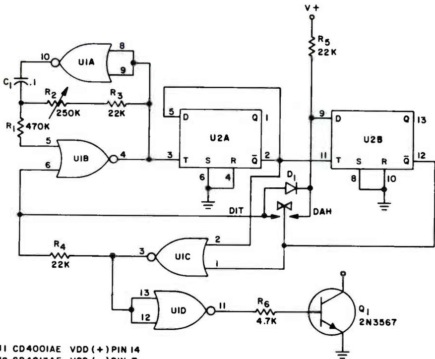
FIGURE 1. SCHEMATIC OF QRPP KEY.
