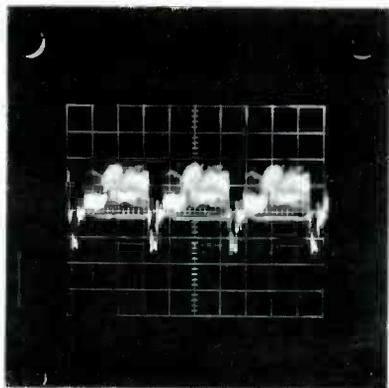
**FIGURE 3. VIDEO SIGNAL AT 20 MICROSECONDS/CM.**
