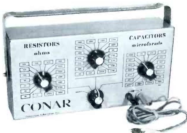
**FIGURE 2. THE MODEL 201 COMPONENT SUBSTITUTION BOX.**
