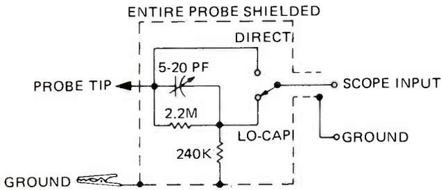
FIGURE 4. A COMBINATION DIRECT LOW-CAPACITANCE PROBE.
