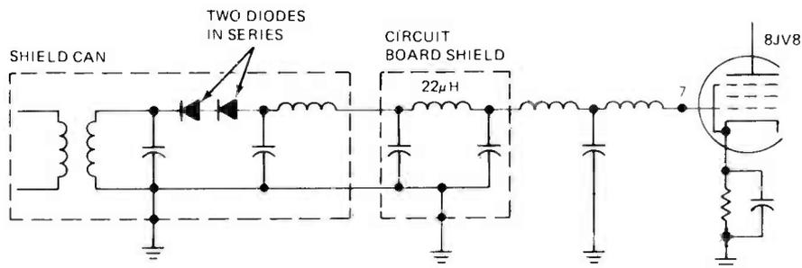
FIGURE 2. ACTUAL CIRCUIT OF TRUETONE VIDEO DETECTOR.
