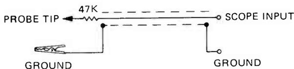
FIGURE 5. ADDING A RESISTOR AT THE PROBE END OF THE CABLE ISOLATES THE CIRCUIT UNDER TEST FROM THE INPUT CAPACITANCE.
