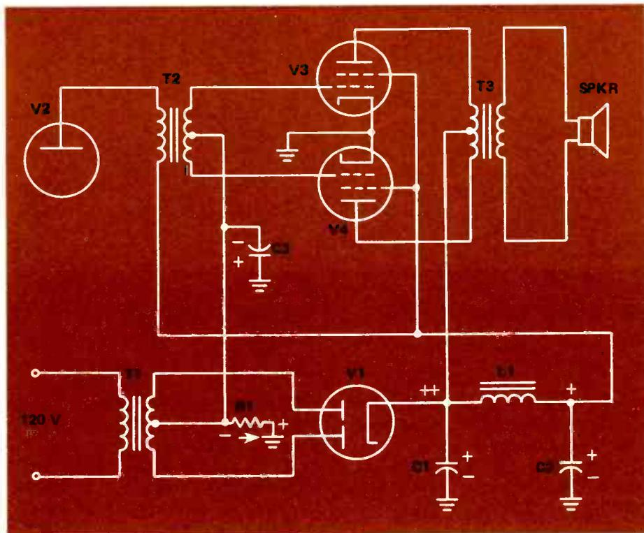
FIGURE 6. POWER SUPPLY AND PUSH-PULL OUTPUT STAGE OF TUBE-TYPE AMPLIFIER.
