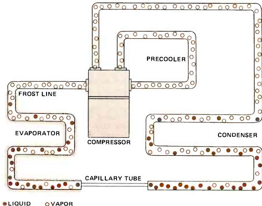
**FIGURE 1. THE NORMALLY OPERATING REFRIGERATION SYSTEM.**
