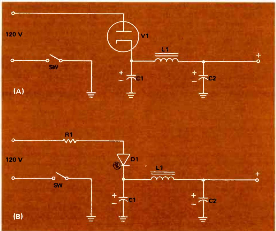
FIGURE 4. TYPICAL HALF-WAVE RECTIFIER CIRCUIT.
