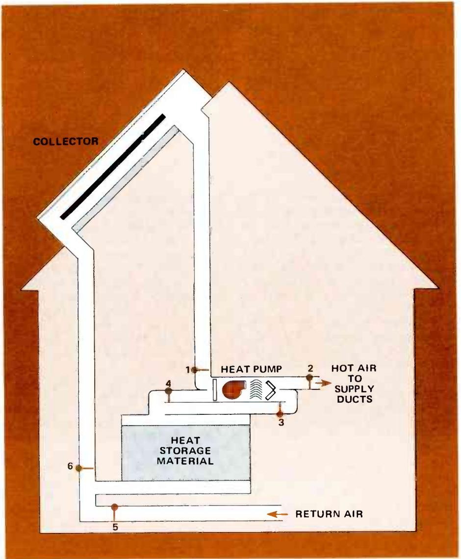
FIGURE 5. A HEAT-PUMP-ASSISTED SOLAR SYSTEM.
