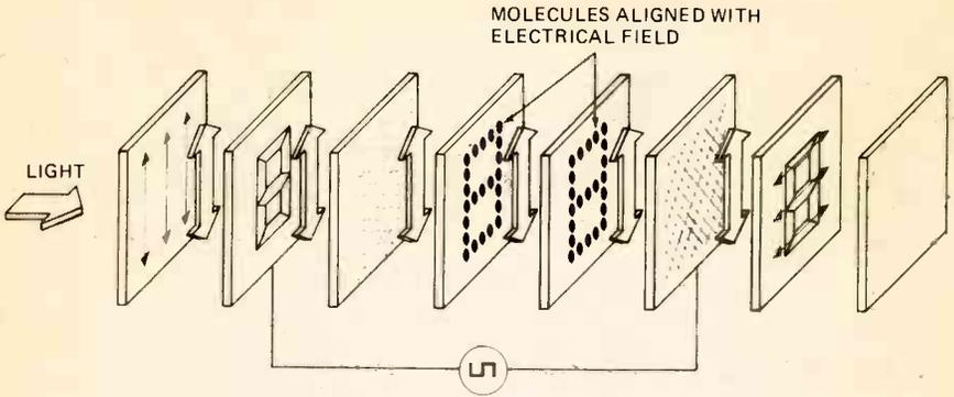
FIGURE 3. ENERGIZED REFLECTIVE LCD.
