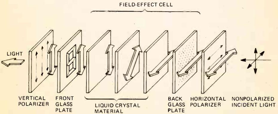
FIGURE 4. UNENERGIZED TRANSMISSIVE LCD.
