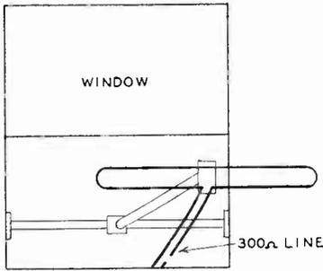
Fig. 13. Window type antenna.
