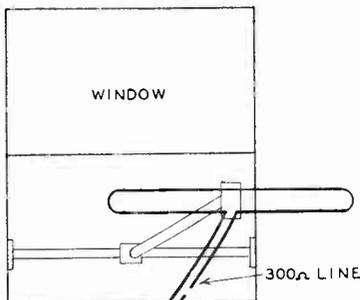
Fig. 13. Window type antenna.
