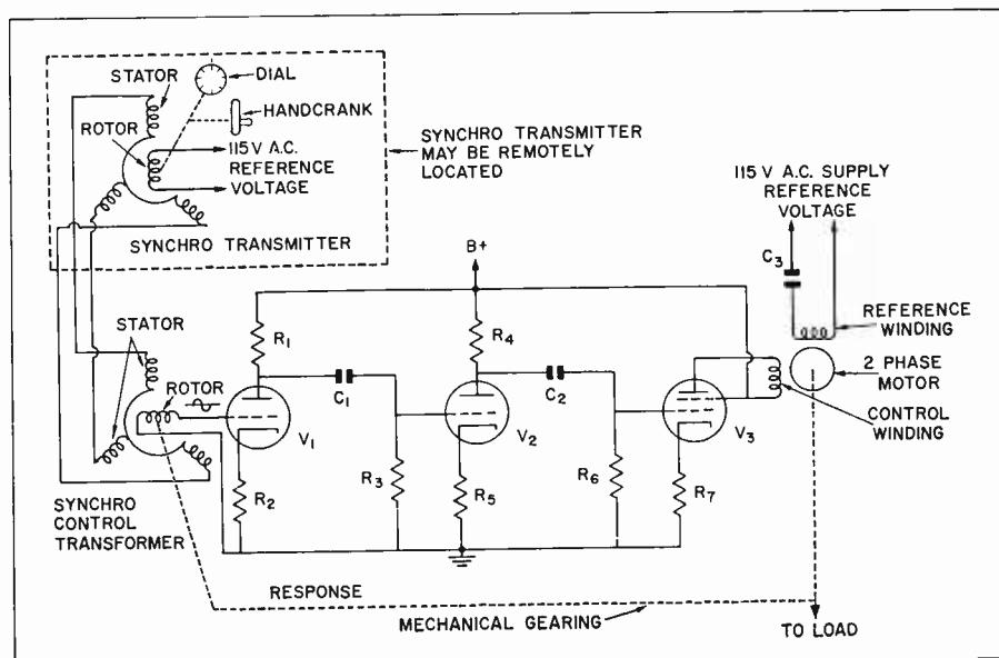
Fig. 1. A simple positioning servo.
