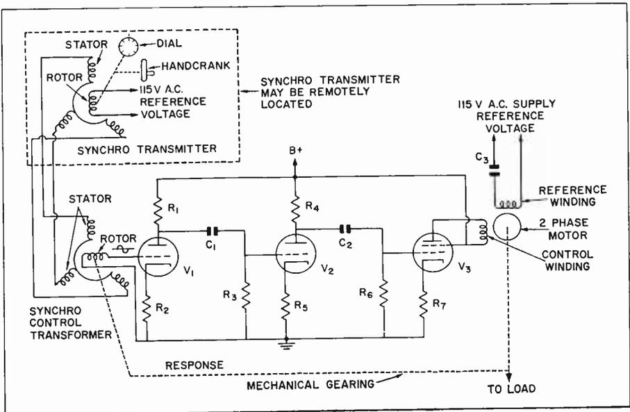
Fig. 1. A simple positioning servo.
