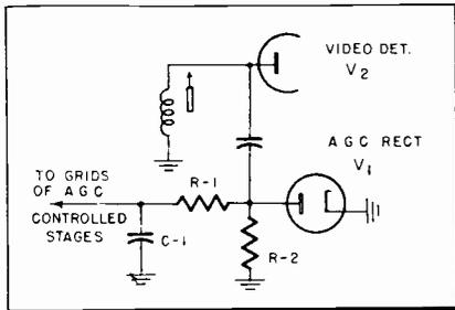
Fig. 4—Simple TV AGC circuit.
