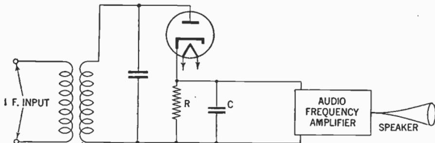
FIG. 21—Diode detector circuit.
