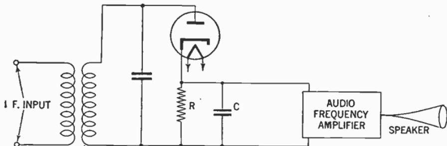
FIG. 21—Diode detector circuit.
