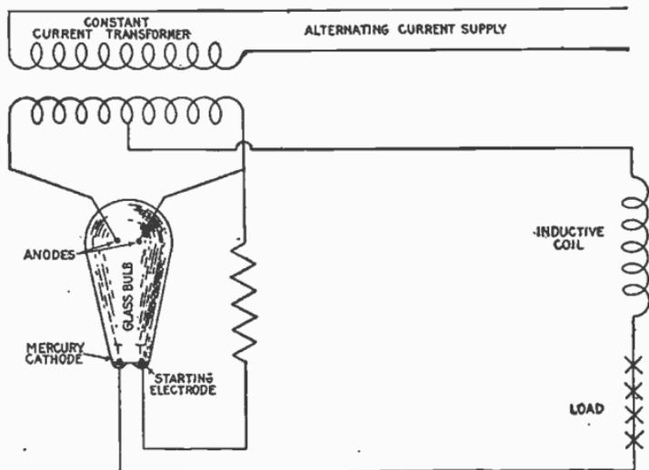
FIG. 4,353.—Cooper Hewitt Mercury vapor rectifier.
