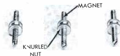
**Fig. 7. Beam-Positioning Magnets.**
