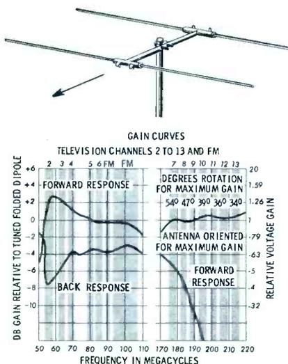
Fig. 1. Mallet Antenna
