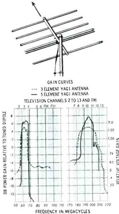
Fig. 5. Yagi Antenna.
