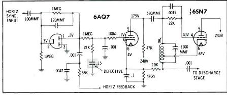
Fig. 1. Gruen horizontal AFC circuit.
