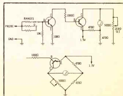
Fig. 16. Simplest transistor voltmeter.
