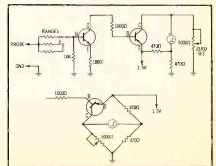
Fig. 16. Simplest transistor voltmeter.
