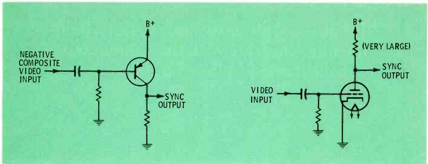
Fig. 4 Sync separator for negative video.
