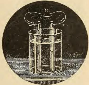
FIG. 114. VOLTAIC ELEMENT
