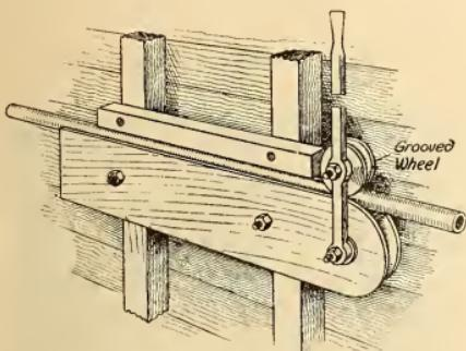
Fig. 1. Plank and Lever Conduit Bender
