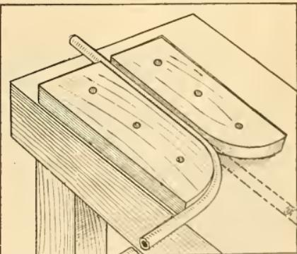
Fig. 2. Work Bench Conduit Bender
