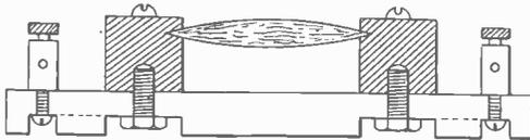
FIG. 1. SIMPLE MICROPHONE.
