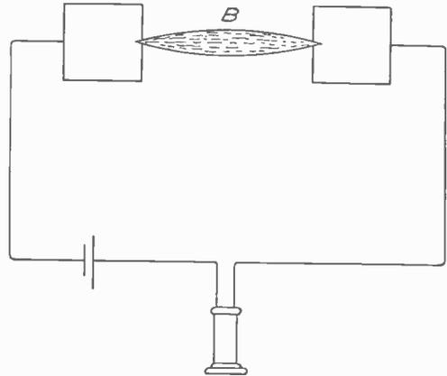
FIG. 2. DIAGRAM FOR CONNECTING UP THE MICROPHONE.
