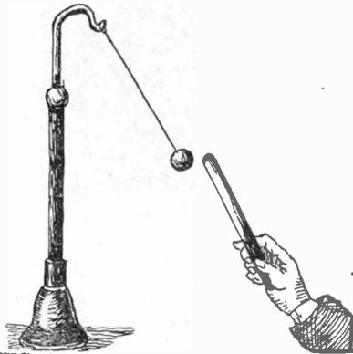
FIG. 1. THE ELECTRIC PENDULUM.
