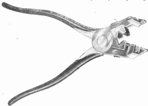
COMBINED INSULATION CUTTER AND PLIERS
