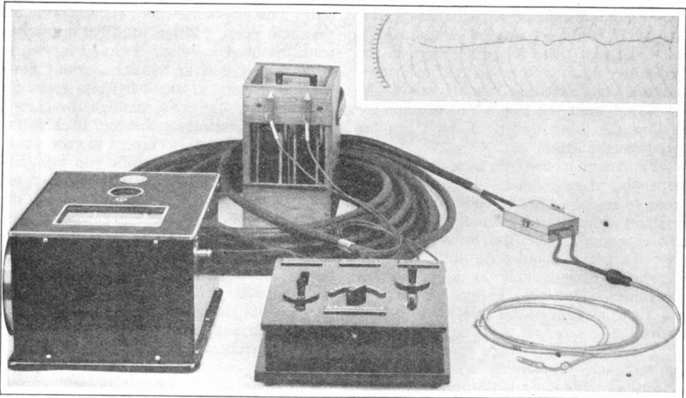
FEVER TEMPERATURE RECORDING APPARATUS AND ONE OF THE RECORDS
