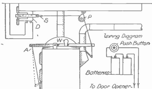
CONTROL ARRANGEMENT FOR HEATING SYSTEM
