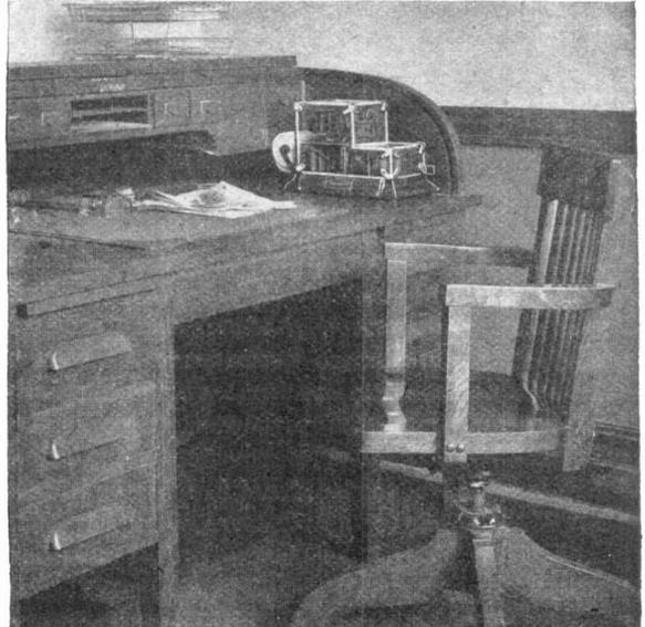
THE RECORDER IS A SMALL AUTOMATIC PRINTING MACHINE KEPT ON THE DESK OF THE PROPRIETOR.
