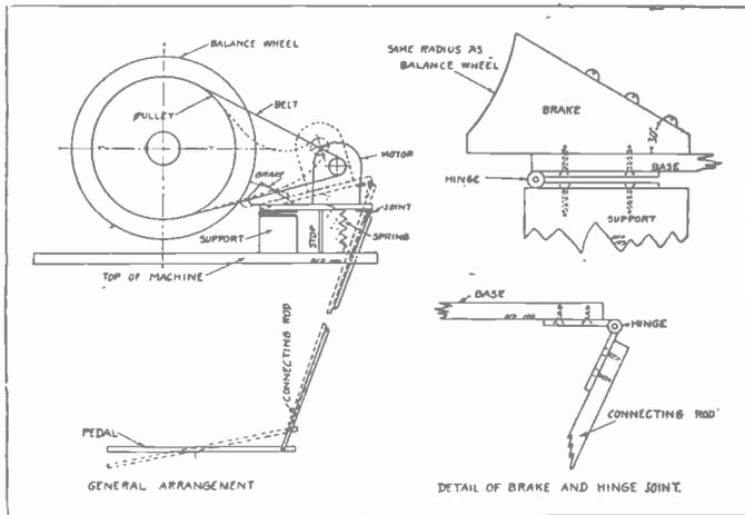
SEWING MACHINE MOTOR AND BRAKE
