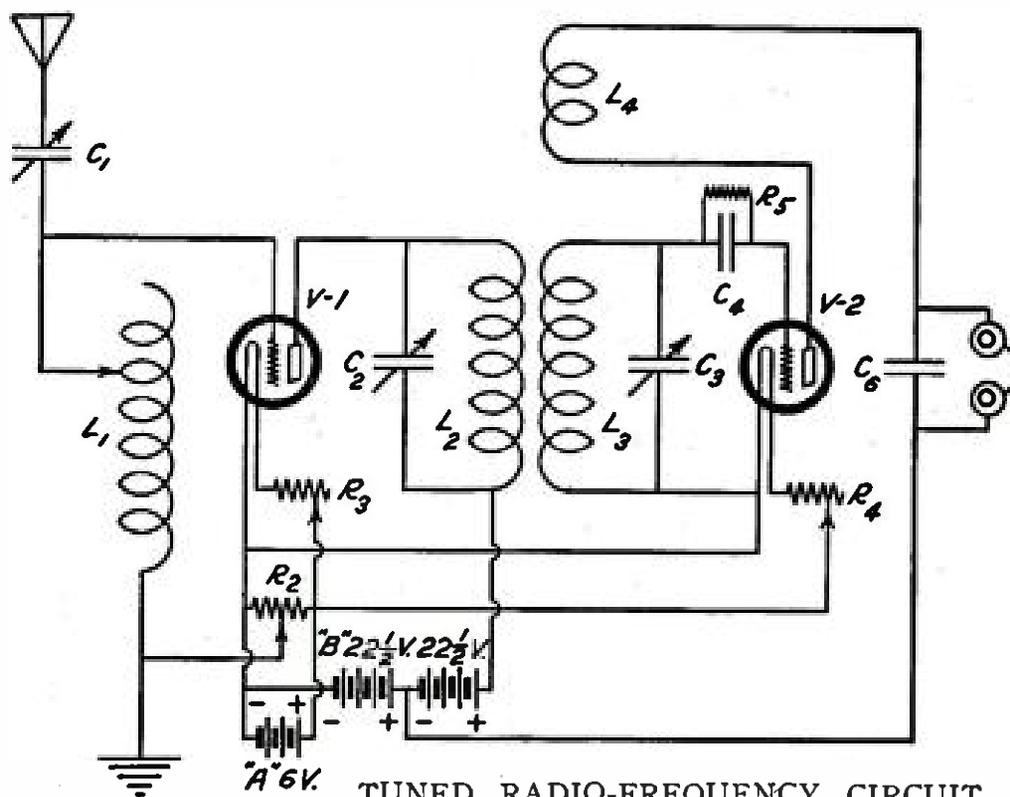
TUNED RADIO-FREQUENCY CIRCUIT
