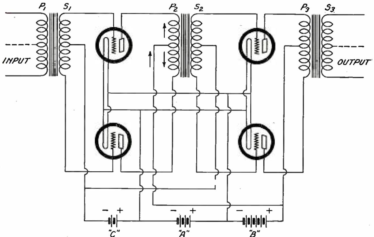
TWO STAGES OF PUSH-AND-PULL AMPLIFICATION
