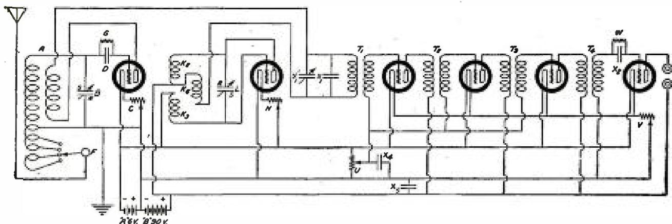
A SUPERHETERODYNE CIRCUIT FOR AIR-CORE INTERMEDIATE-WAVE TRANSFORMERS
