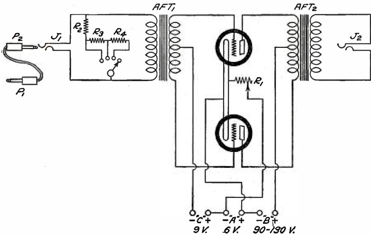
ONE STAGE OF PUSH-AND-PULL POWER AMPLIFICATION
