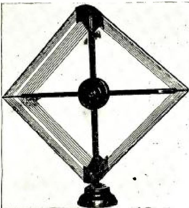
*A collapsible loop antenna.*
