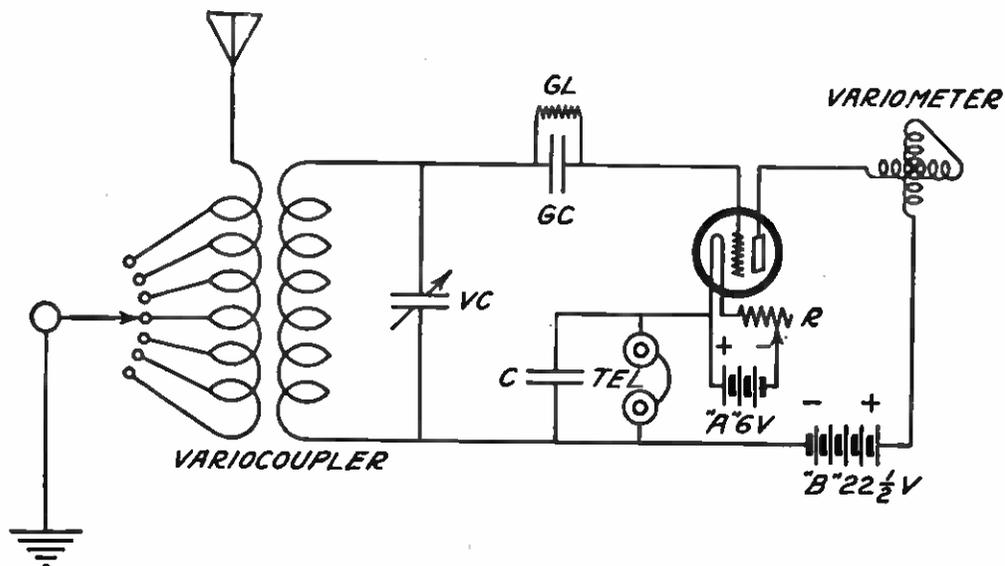
THE COMBINATION TUNED-PLATE, ULTRA-AUDION CIRCUIT
