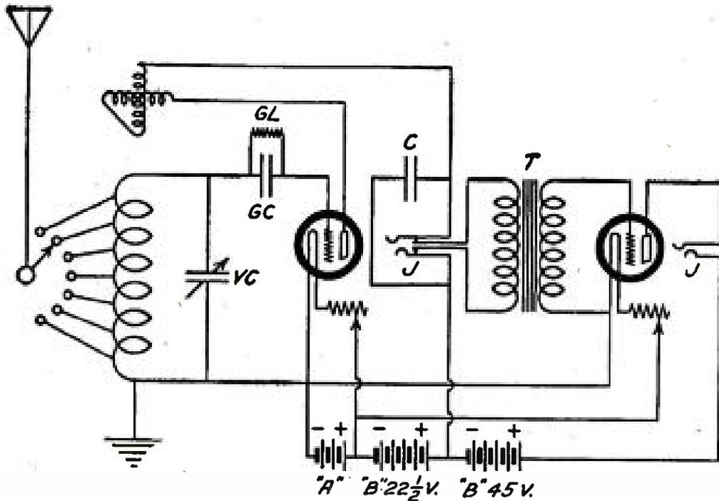
THE CONDUCTIVELY-COUPLED, TUNED-PLATE REGENERATIVE CIRCUIT WITH ONE STAGE OF AUDIO-FREQUENCY AMPLIFICATION
