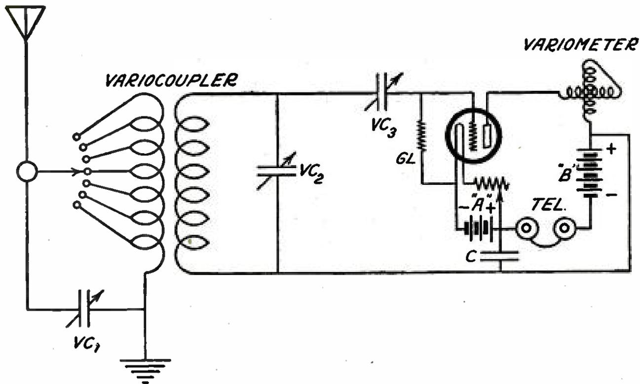
TUNED-PLATE ULTRA-AUDION CIRCUIT WITH FINER CONTROLS
