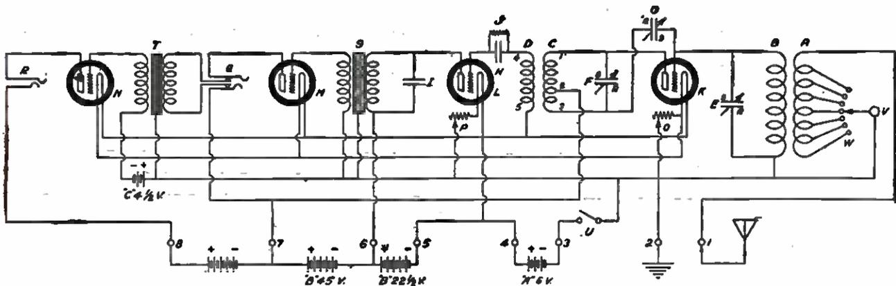
**THE CRAIG CIRCUIT, EMPLOYING THE PRINCIPLE OF TUBE-CAPACITY NEUTRALIZATION**
