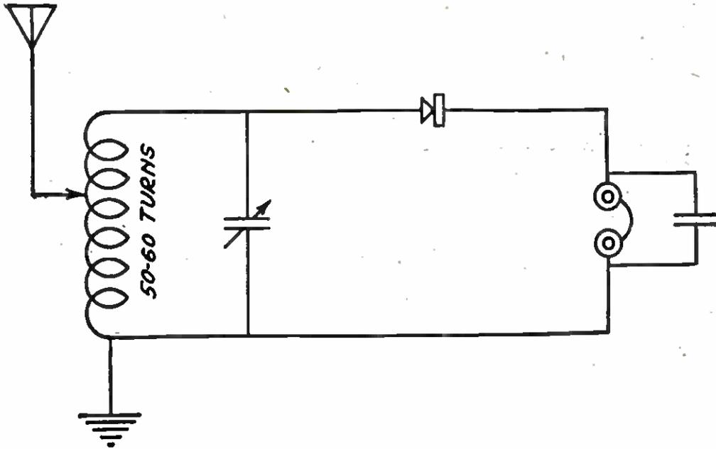
THE CAPACITY-TUNED CRYSTAL CIRCUIT
