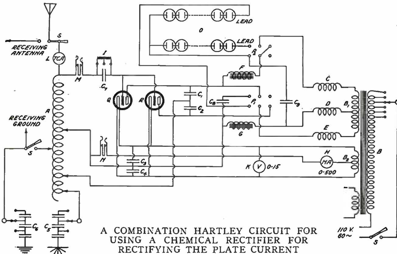
A COMBINATION HARTLEY CIRCUIT FOR USING A CHEMICAL RECTIFIER FOR RECTIFYING THE PLATE CURRENT
