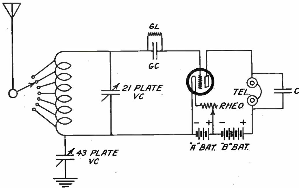
**CONDUCTIVELY-COUPLED, CONDENSER-TUNED, VACUUM-TUBE CIRCUIT**
