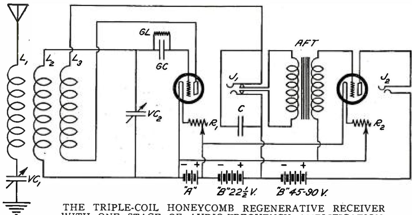
THE TRIPLE-COIL HONEYCOMB REGENERATIVE RECEIVER WITH ONE STAGE OF AUDIO-FREQUENCY AMPLIFICATION
