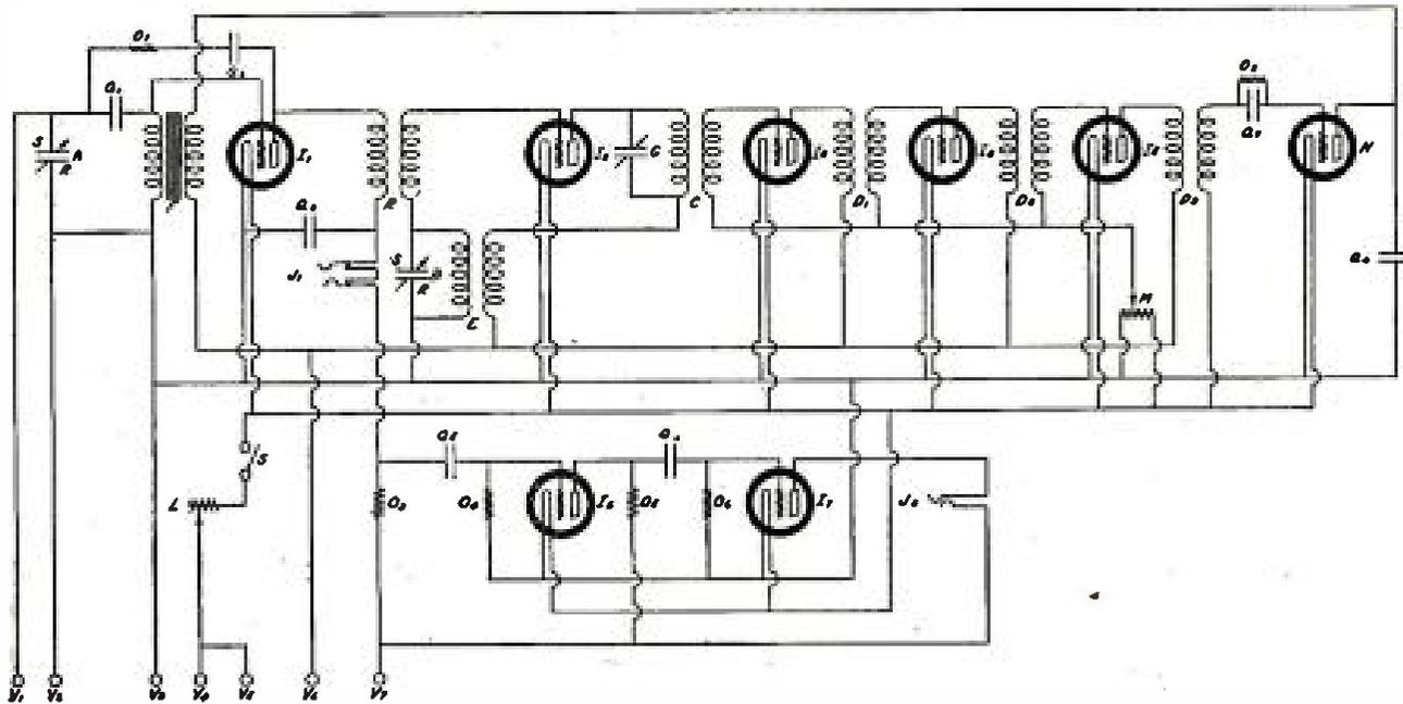
8-TUBE SUPERHETERODYNE REFLEX CIRCUIT
