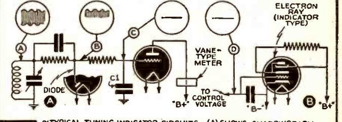
FIG. 18 ~TYPICAL TUNING INDICATOR CIRCUITS. (A) SHOWS SHADOWGRAPH TUBE TYPE. (B) SHOWS CATHODE-RAY TUNING INDICATOR TUBE TYPE.~
