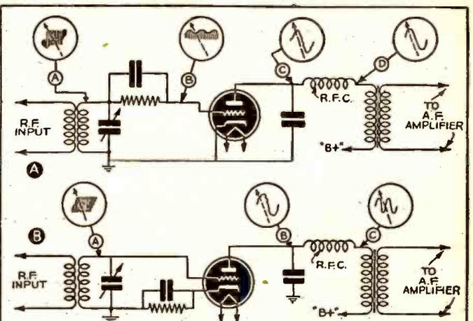
FIG. 15 ~TYPICAL TRIODE DETECTORS. (A) IS GRID-LEAK TYPE, (B) IS BIASED DETECTOR TYPE.~
