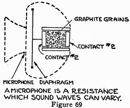
A MICROPHONE IS A RESISTANCE WHICH SOUND WAVES CAN VARY.
