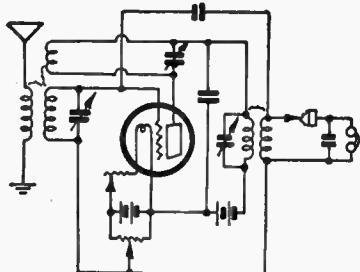
TUBE CAPACITY NEUTRALIZED
