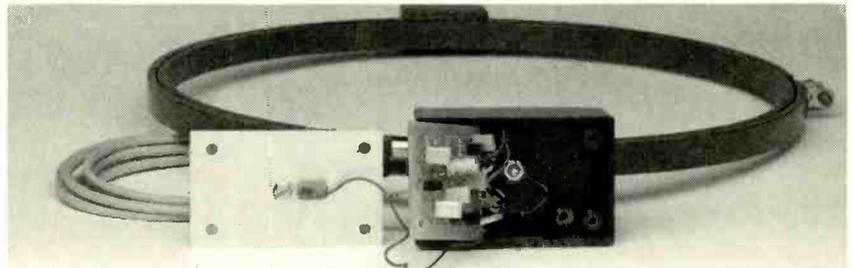
**ANTENNA-TUNER AMPLIFIER ASSEMBLY.**
