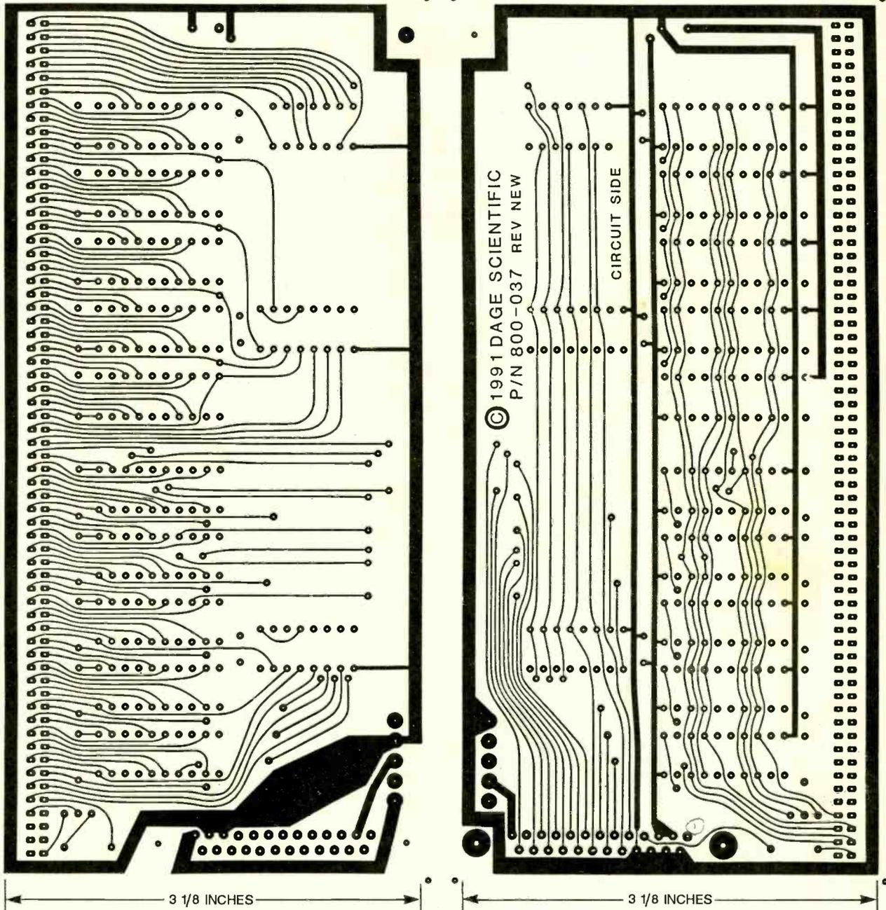
FOIL PATTERNS FOR THE PC I/O BREADBOARD shown actual size.
