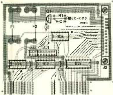
FIG. 4—INTERFACE CARD parts-placement diagram.
